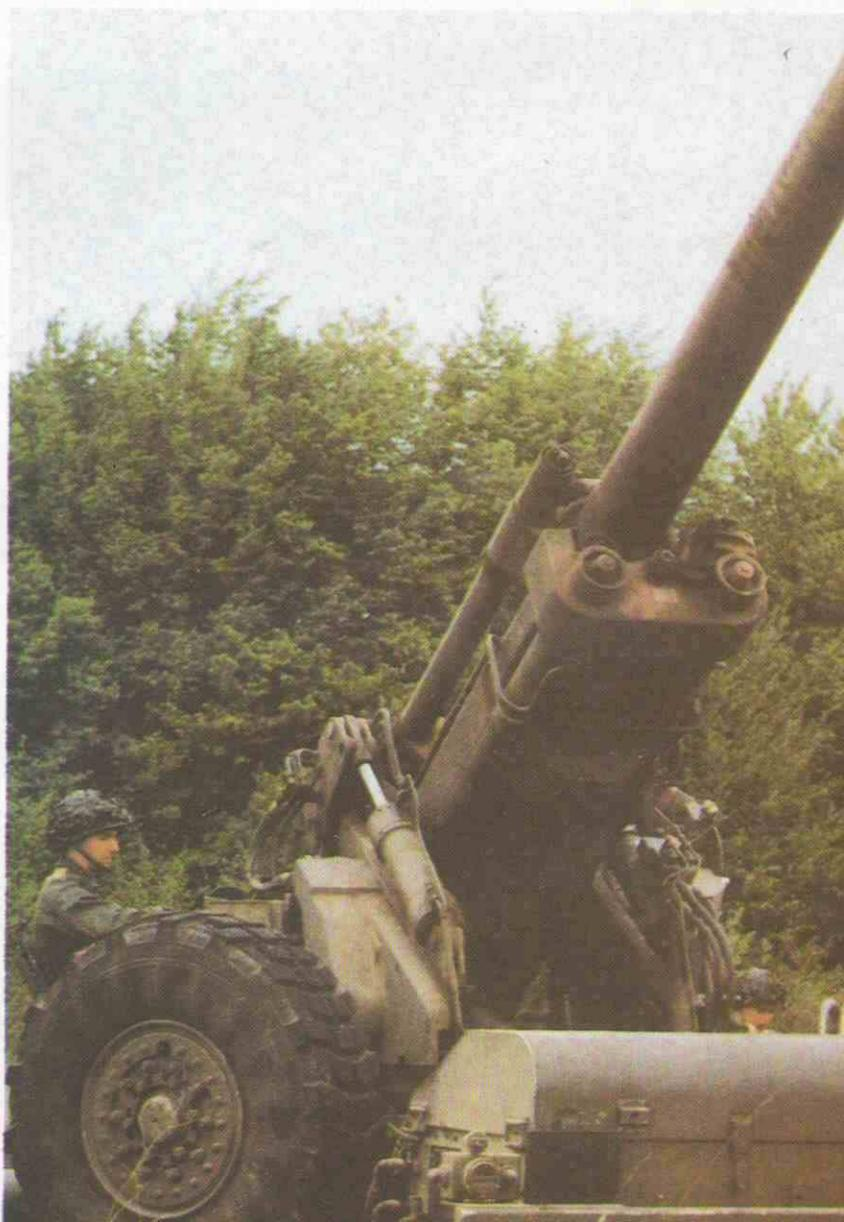
La pieza va dotada de un motor Citroën de 39 HP., que le permite desplazarse a 10 km/h. La boca de fuego es de 40 calibres de longitud, siendo el cierre de cuña horizontal. El sistema de puntería, así como la carga, y la entrada y salida de posición son enteramente hidráu-
