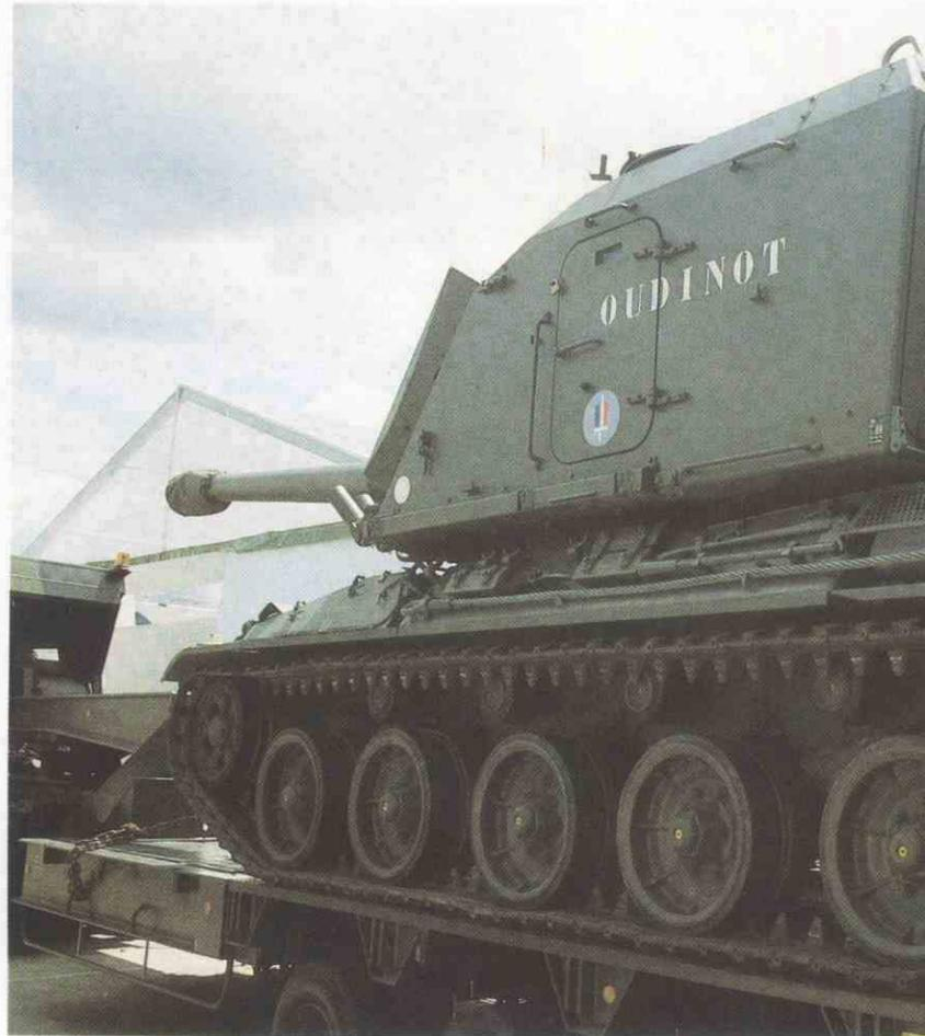
que las del 155TR (Tracté), del que ya hemos hablado anteriormente, destacaremos aquí su peso en combate que es de 42 Tn.; la velocidad máxima en carretera, de 60 km/h., la autonomía, de 450 km. a 40 km/h.; que salva pendientes del 60%, obstáculos verticales de 0,93 m. y zanjas de 1,90 m.
