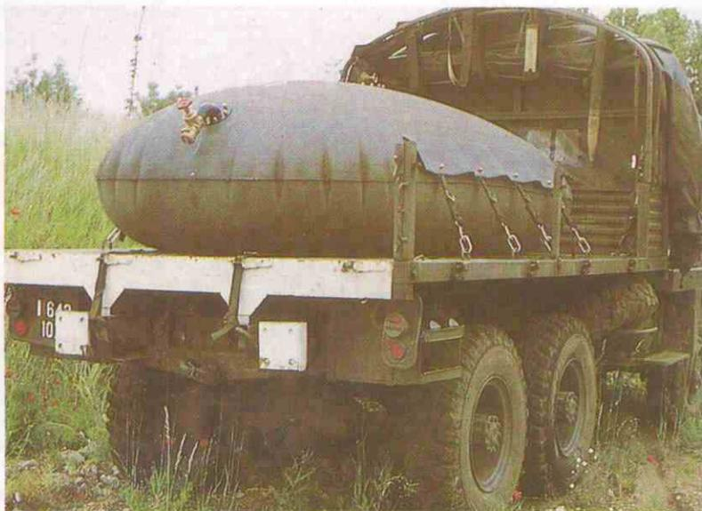
Depósito transportable en camión.
