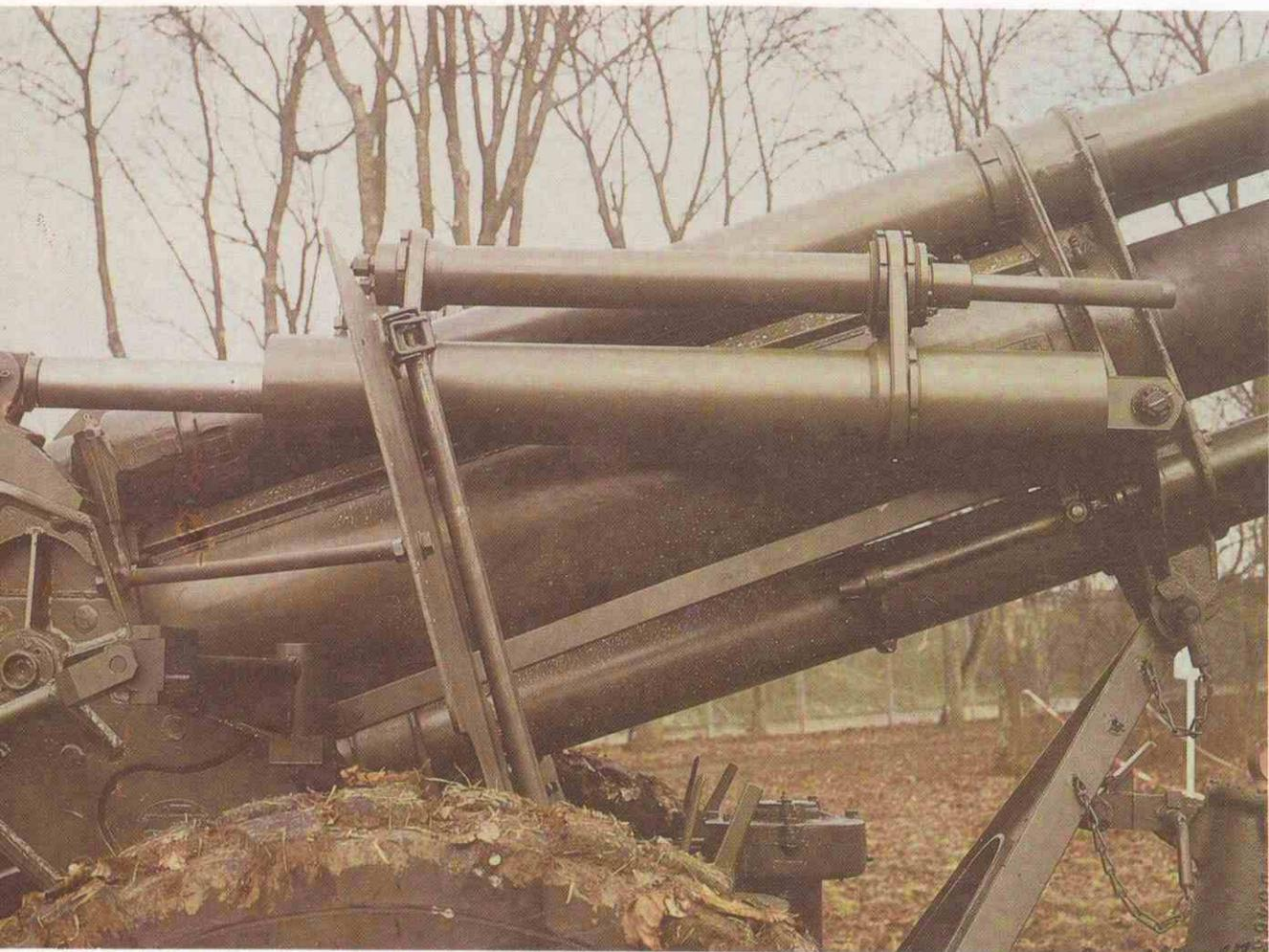
**Detalle de la modernización del obús americano de 155/23 M114 según el proyecto de modernización del GIAT que sustituye el tubo de 23 calibres por el de 39.**
