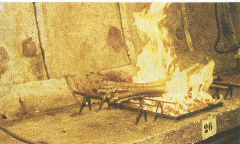
Pruebas de incendio, en el metropolitano de Milán. Arriba: cables tradicionales. Abajo: de baja emisión de humos.
