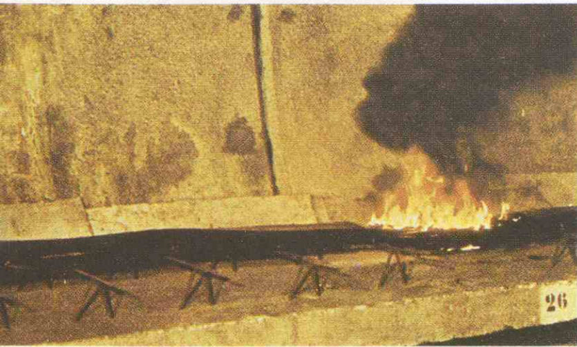
Pruebas de incendio, en el metropolitano de Milán. Arriba: cables tradicionales. Abajo: de baja emisión de humos.
