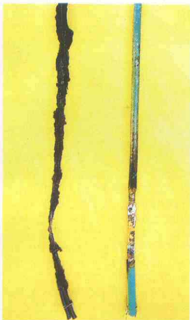
Estado final de dos muestras de cables distintos, una de cable normal y otra de cable no propagador del incendio después de realizadas las pruebas.
