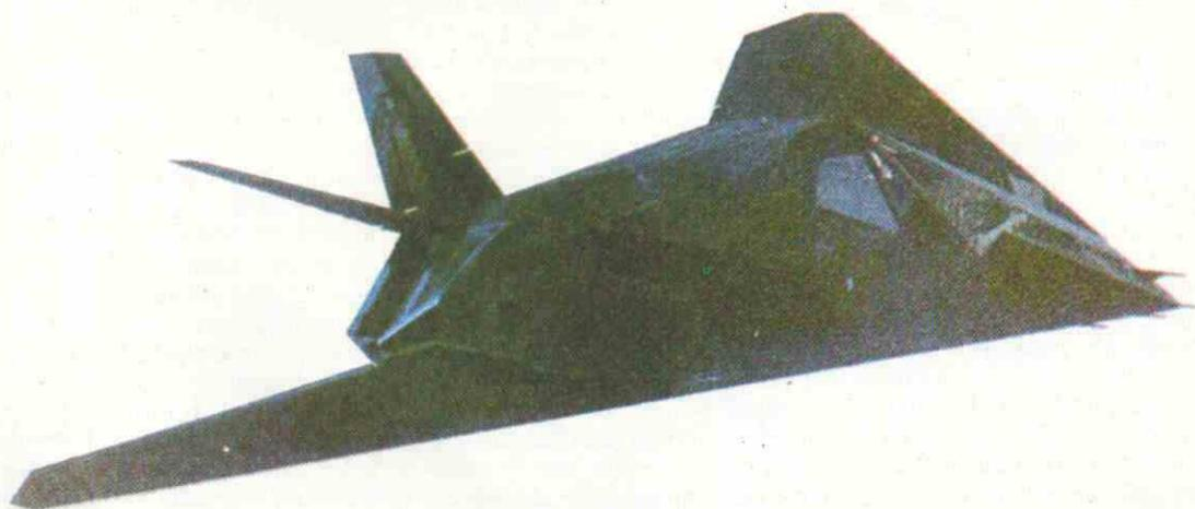
base de materiales absorbentes de las radiaciones radar y toberas que dispersan rápidamente el calor producido por los gases de escape de los motores.
