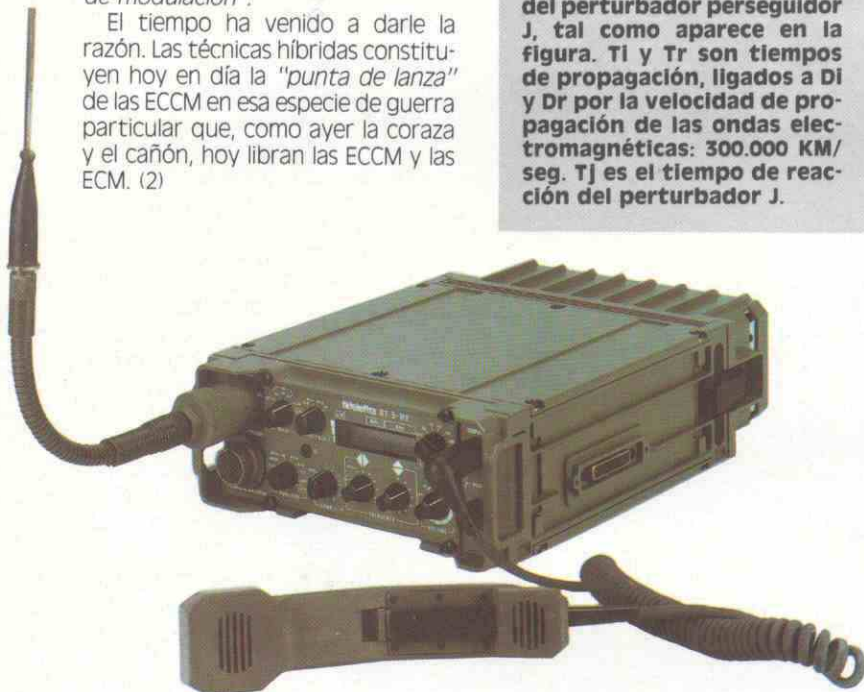
Versión portátil (RTFM tipo PRC) del HYDRA-V.
