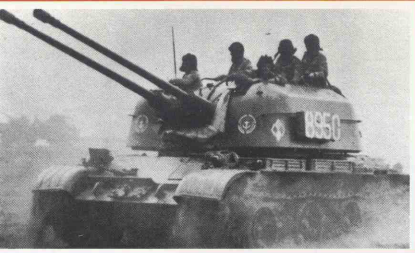
El T-54 y el T-55 constituyeron la base de vehículos de artillería antiaérea tales como el ZSU-57-2.
