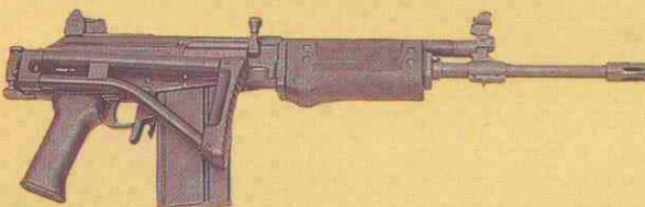
GALIL de fabricación israelí, 7,62 mm., con su culatín metálico plegado hacia adelante para reducir así su longitud (abajo), versión corta para fuerzas paracaidistas y aerotransportadas.
