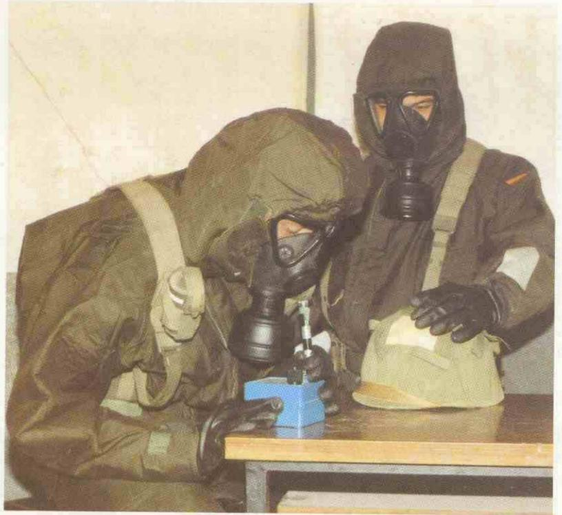
**Componentes de un equipo de control realizan la lectura de un radiómetro para verificar la radiación existente.**
