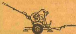
ZU-23 m. 2 x 23 mm. Óptica. 2.500 m alcance eficaz teórico.
