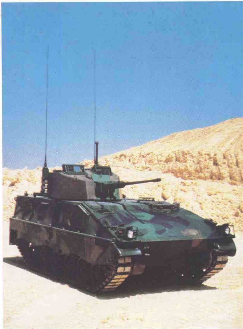
Prototipo del VCI. ASCOD (obsérvese el mástil para la medición de la velocidad y dirección del viento a la derecha de una de las antenas).
