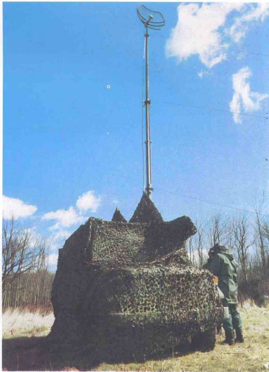
Radioenlace táctico ST 701 de ALCATEL ATFH. Funciona en las bandas I, II, III y IV EUROCOM. Dispone de EPM integrada. (Espectro Ensanchado por Modulación Directa). Es un equipo concebido para una red dotada de una Alta Capacidad de Supervivencia.
