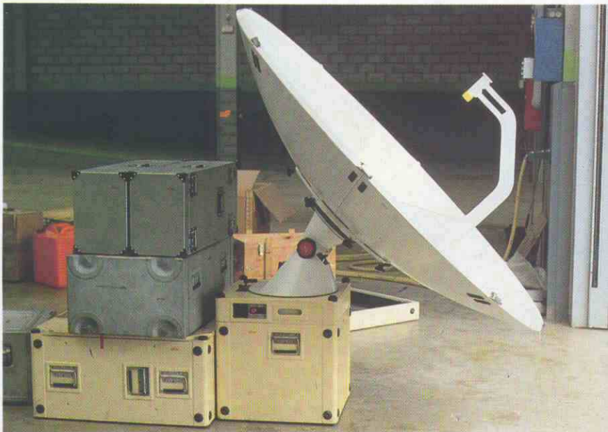
Terminal de Telefónica portátil, con antena de una pieza, de 1,9 metros de diámetro. Todo el equipo cabe en 7 cajas y pesa 300 kg.
