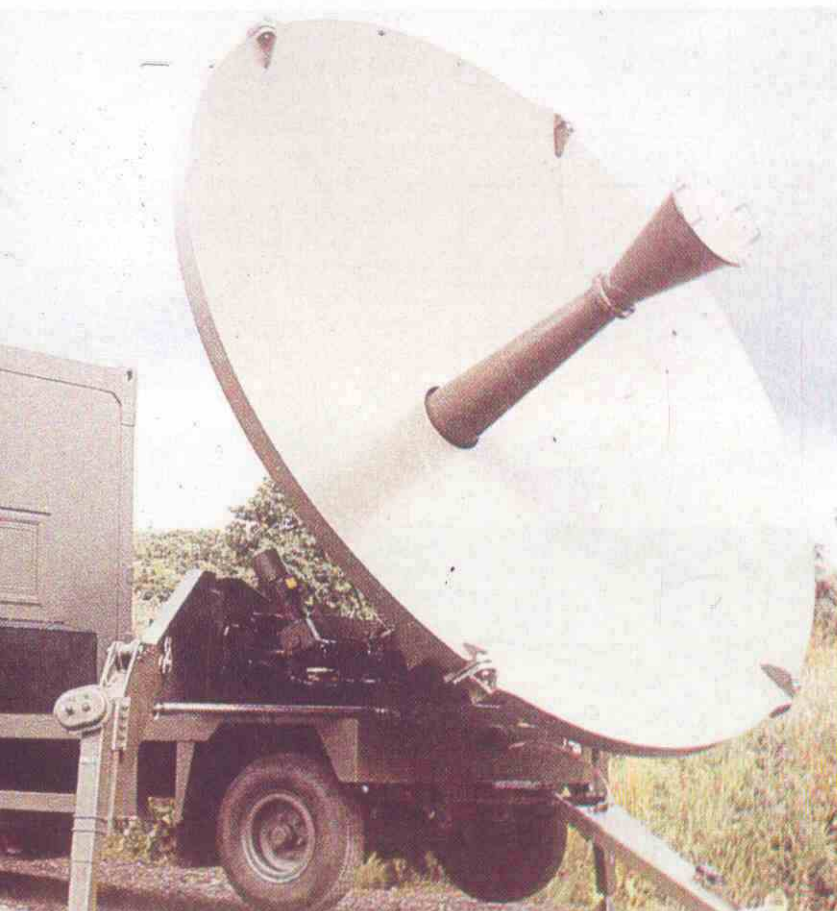
Terminal transportable MARTLET de la red SKYNET IV, con antena de 4,5 metros.
