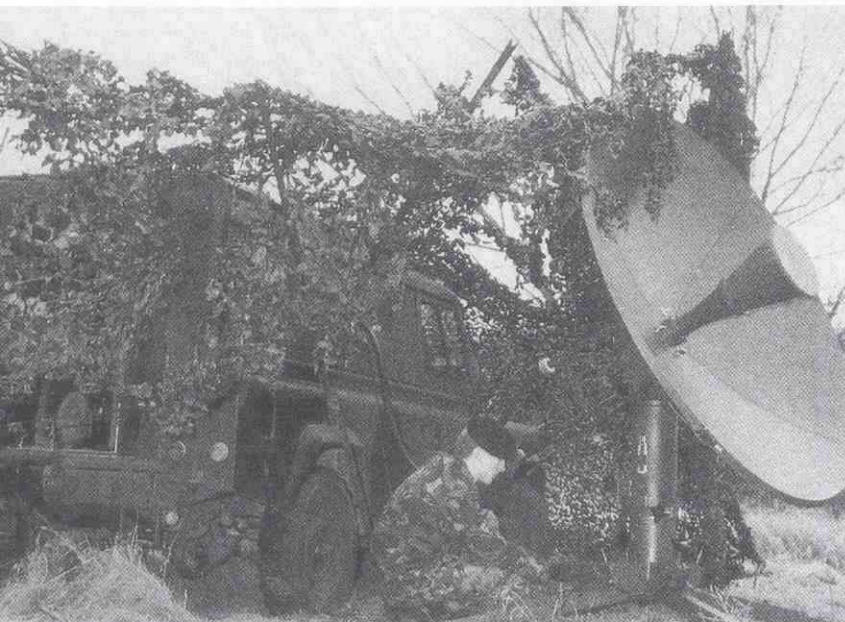
Terminal UK/VSC-501 sobre CLTT 3/4 (de Racal) en uso en la red SKYNET IV. Su antena es de 1,9 metros y proporciona seis canales duplex: Voz/datos a 16 Kbps; voz/datos a 2,4 Kbps; y 4 canales telegráficos a 50, 75 ó 110 baudios.
