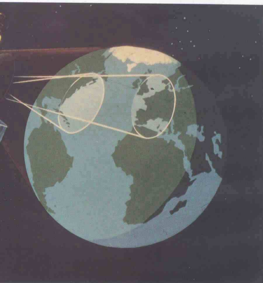
Satélite INTELSAT IV, de forma cilíndrica, estabilizado en un eje, mostrando las coberturas de sus antenas sobre la superficie terrestre.
