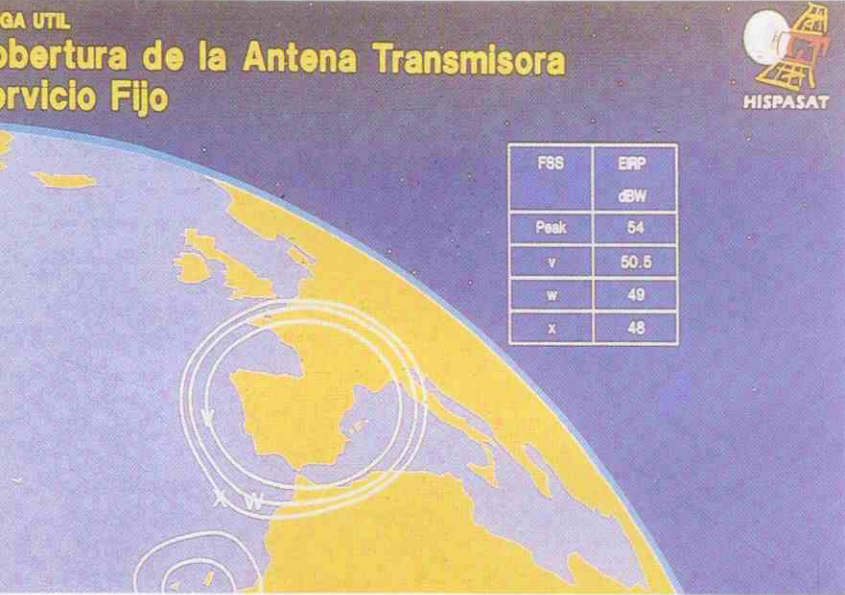
Misión del Servicio Fijo por Satélite. Cobertura de la antena transmisora. Menos potente que la de Difusión Directa, se compone asimismo de dos focos: uno sobre la Península-Baleares y otro sobre Canarias.
