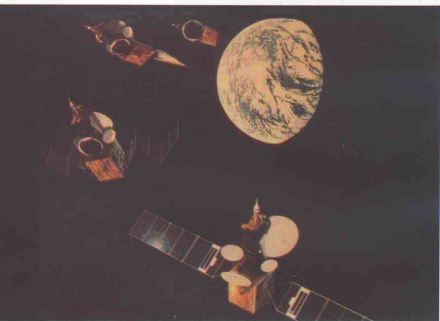
Satélite INTELSAT V, estabilizado en 3 ejes. Se muestran las fases del despliegue.
