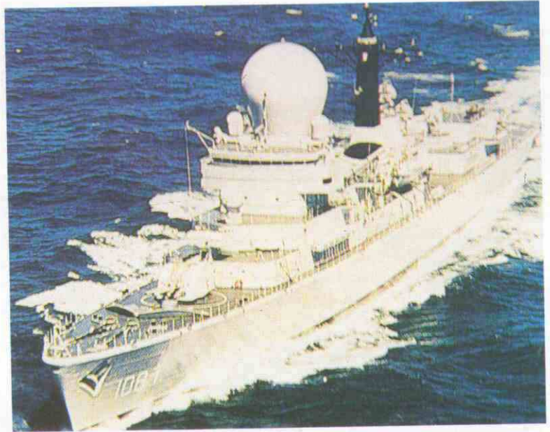
Terminal naval SCOT 1D instalado sobre una fragata de la Royal Netherlands Navy. En el modelo 1D los equipos de comunicaciones se instalan en un compartimento interior del buque.
