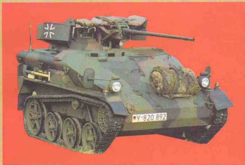
La mayor parte de los vehículos "Wiesel" entregados a las unidades aerotransportadas alemanas, llevan el cañón de 20 mm. REHINMETALL para la defensa contra vehículos acorazados ligeros, helicópteros y aviones en ataque a tierra.
