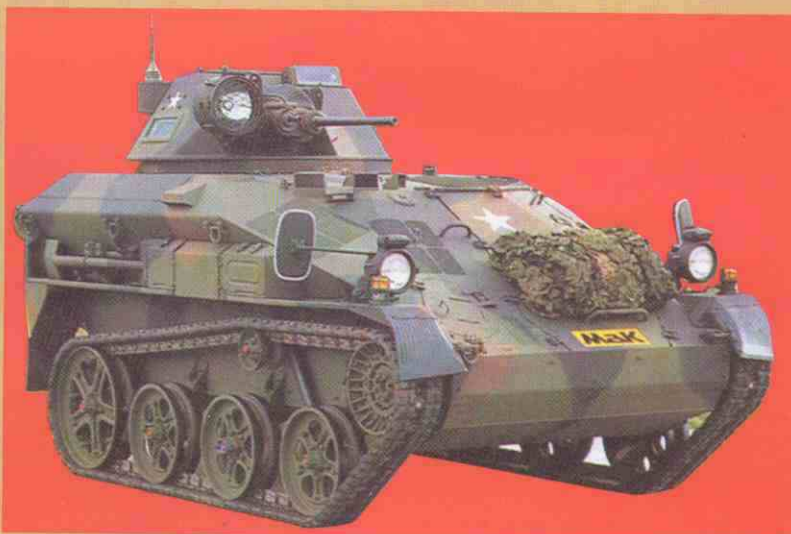
Una de las versiones del "Wiesel" puede ser como vehículo de reconocimiento equipado con torre que monta una ametralladora de 12,7 mm y otra de 7,62 mm.
