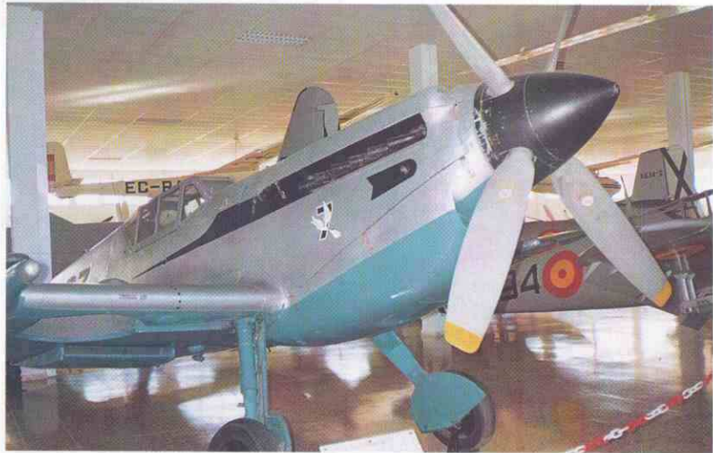
El ME-105 "Buchón" de origen alemán, fabricado en España y con motor inglés...
