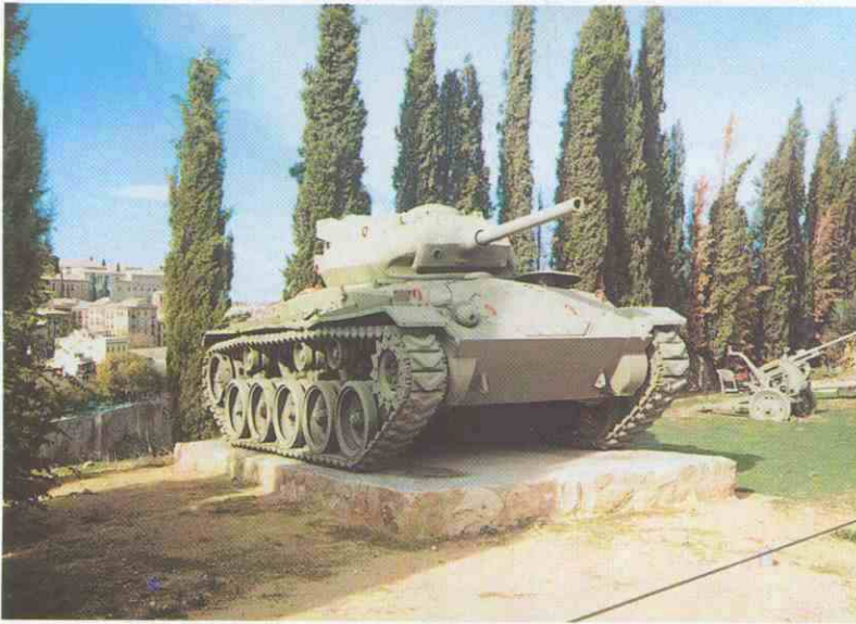
Carro ligero M-24. 18,5 Tm, cañón de 75 mm, motor de gasolina, velocidad 65 km/h.
