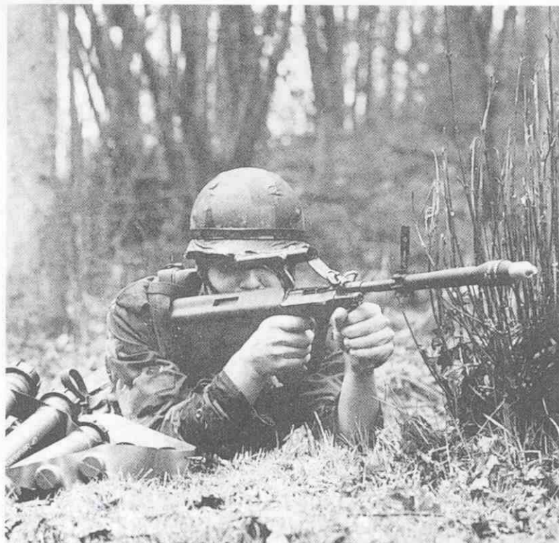
Granada de fusil Mecar M260 "atrapabalas" en el apagallamas del Steyr AUG.
