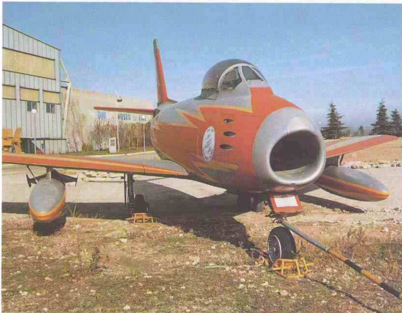
El primer caza-reactor español (de ayuda americana). La foto pertenece a un componente de la Patrulla Acrobática. Obsérvense 3 de las 6 ametralladoras de 12,70 mm.
