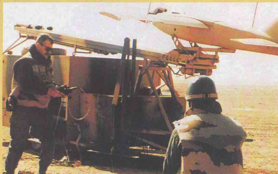
El MART, de origen británico, es un vehículo autoestabilizado de ala alta, monoplano, provisto de patines para el aterrizaje.
