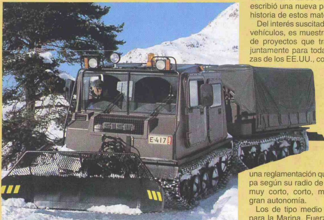
El NA 140 NASU, especial para terreno pantanoso y zonas montañosas, incluso sobre nieve.
