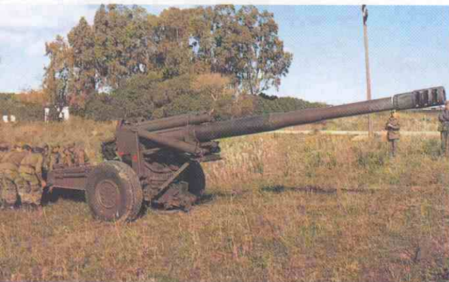
La conversión M-114/39 propuesta por ENSB-FABARDM, no aceptada en España, aunque probada satisfactoriamente. Prestaciones balísticas iguales al "trilateral" FH-70.
