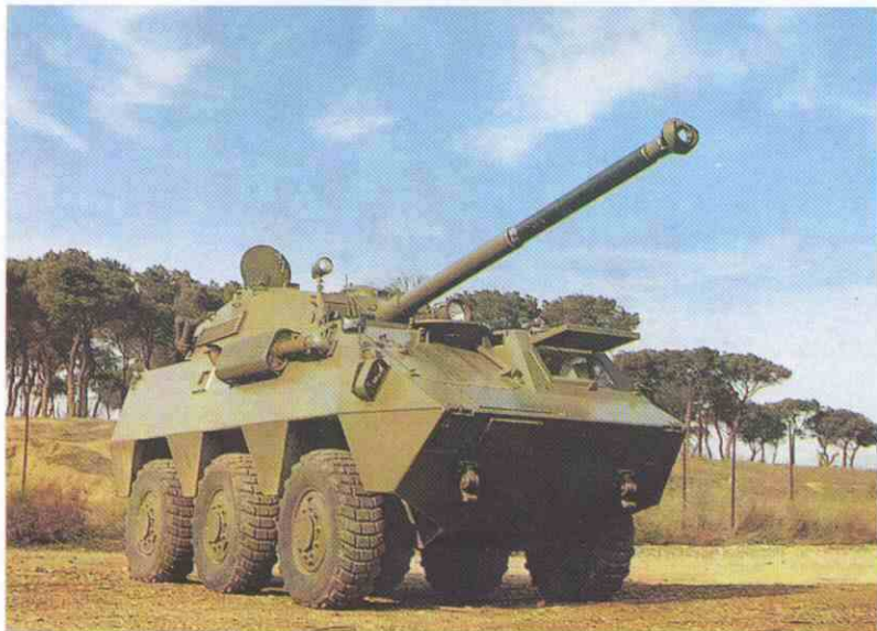
Aunque el armamento normal del VEC. es el cañón "CHAIN GUNB" (M-242) de 25 mm., algunos montan torres de 90 mm.
