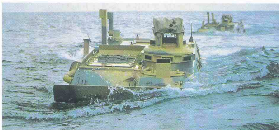
Capacidad anfibia del BMR. (con propulsores "hidrojet" y equipo de navegación en aguas marinas).
