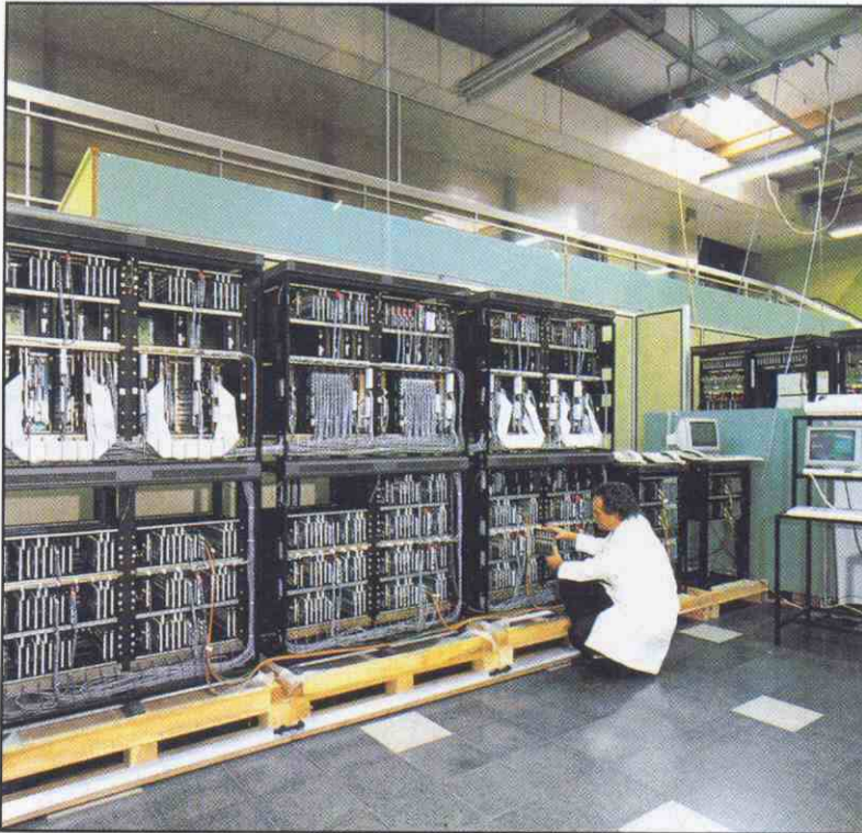
Pruebas de integración de centrales en fábrica
