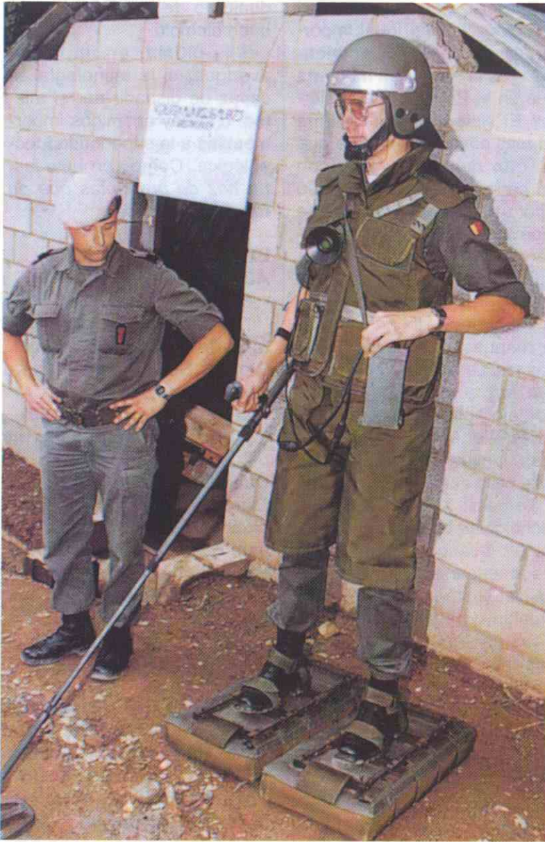
Equipo de zapador para levantamiento de minas. Obsérvense los cojines de aire bajo las botas (VOX n.º 9.328).
