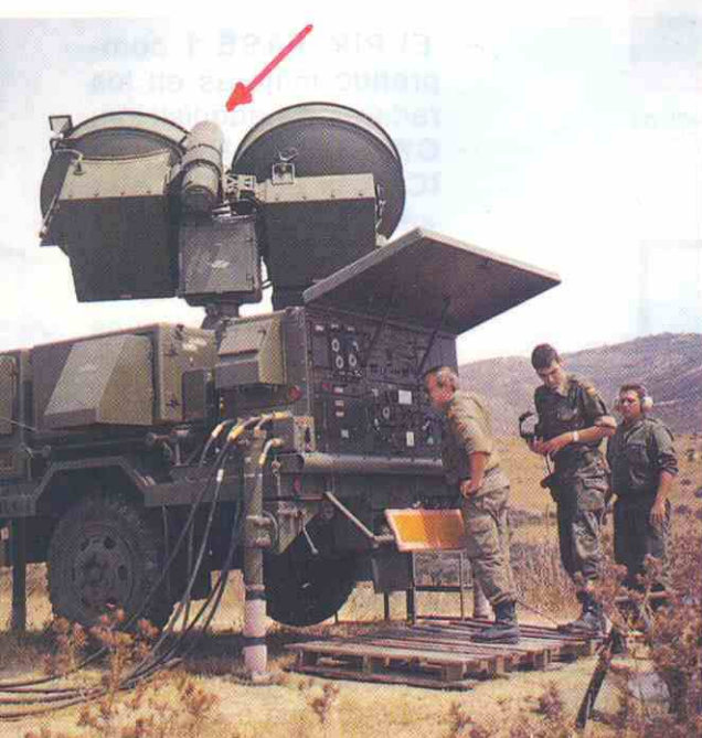
«PIP. II». La cámara de TV del «TAS.» entre las antenas del radar iluminador «HIPIR.» o «HPI.».
