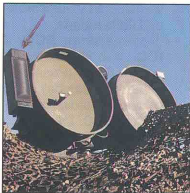
El pedestal de antenas del «HIPIR» con la inclusión, a la izquierda de la antena «LASHE» de lóbulo ancho.
