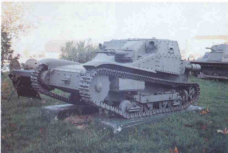
Con la «tanqueta» (L3, o «Carro Veloce» CV 33, unas 3 T.) Italia hizo sus guerras coloniales. Ligera y ágil, aunque no tan veloz (40 km/h), mal armada y con escasa visibilidad. En España fracasó ante los carros rusos T-26, pero no se aprendió la lección y en Libia sucumbieron ante los «Cruisers» y «Matildas» británicos.
