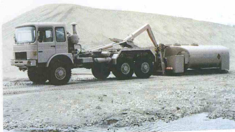
Cisterna con mercancía peligrosa para ser transportada por un VEMPAR
