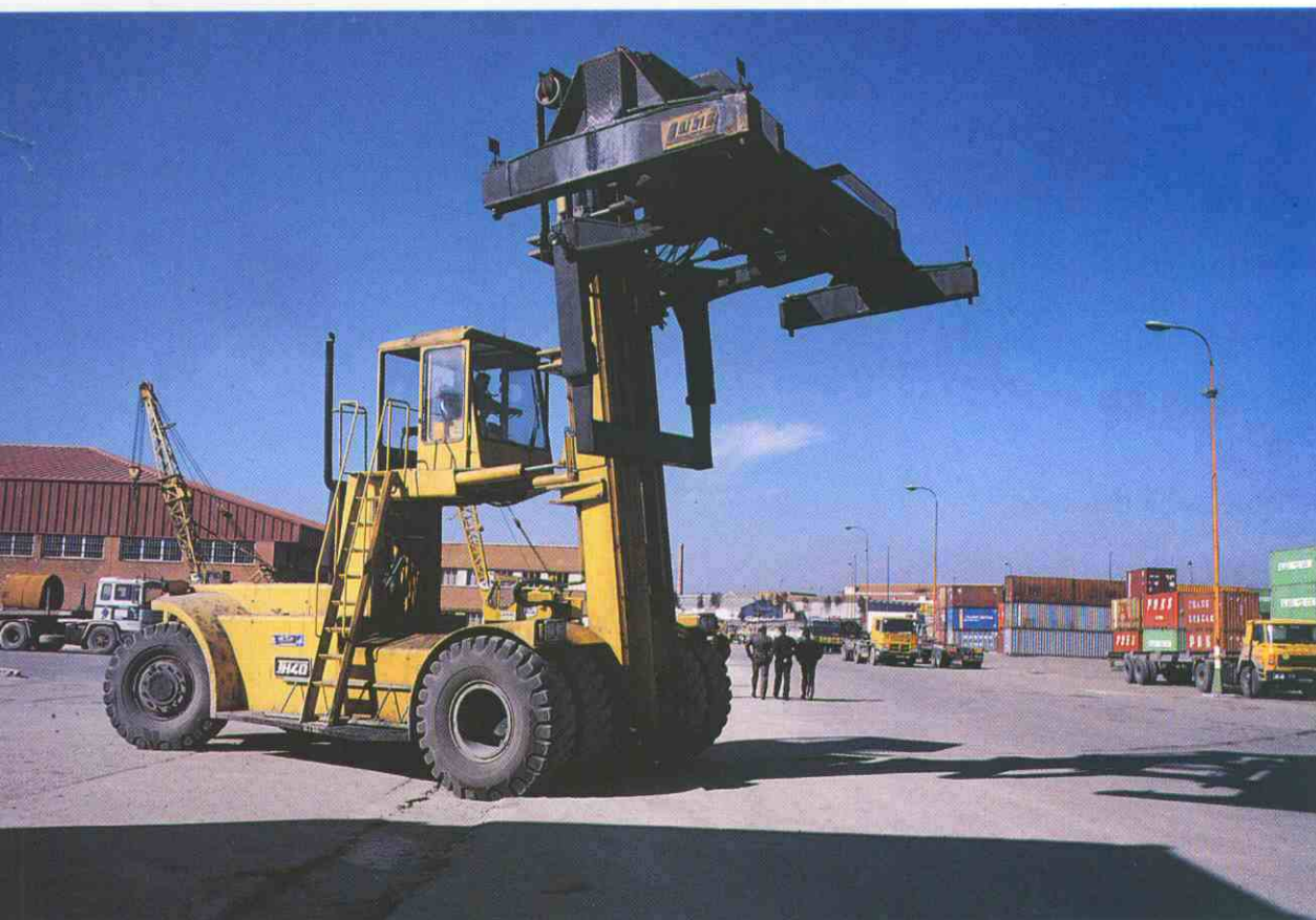
Grúa para carga de contenedores con «spreader» acoplado. Permite la colocación de contenedores de 20 y 40 pies a tres alturas.
