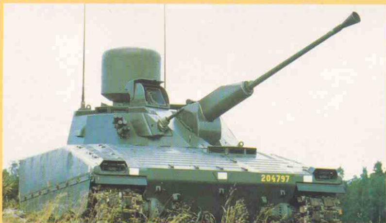
Variante antiáerea del vehículo de combate CV.90 armado con el cañón de 40 mm. Bofors
