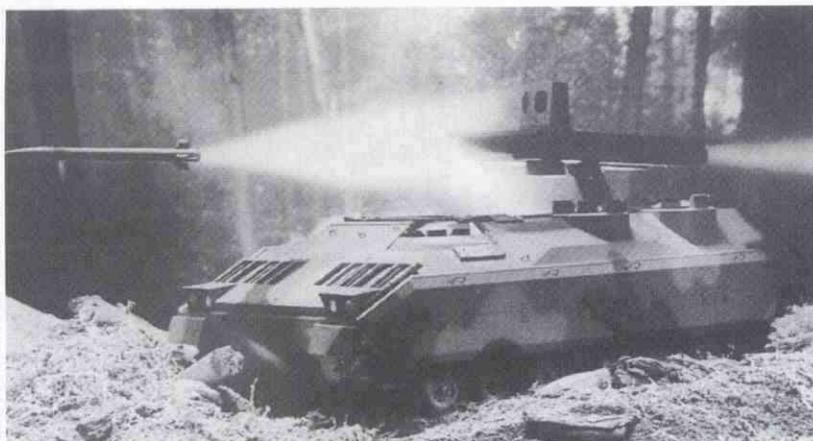
El sistema LOSAT montado en un chasis modificado del BRADLEY lanzando un misil hiperveloz (HVM).
