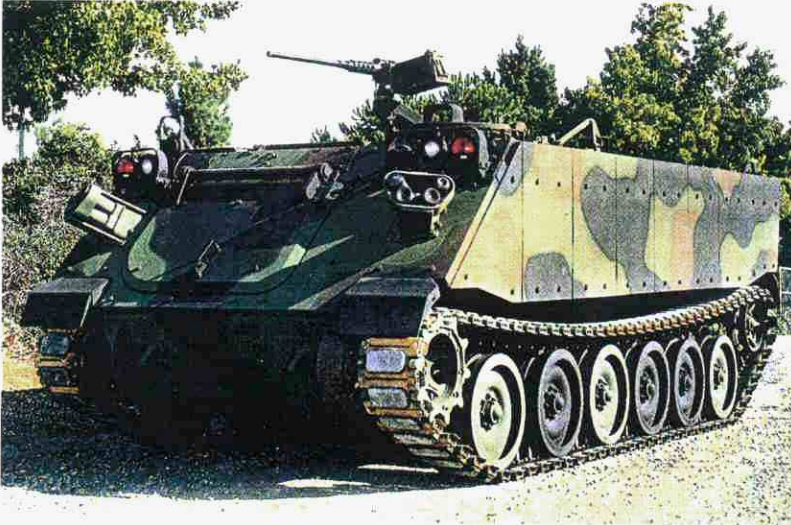
Versión especial M113 A3 S, con más movilidad (obsérvese la sexta rueda guía del tren de rodaje) y longitud. Incorpora un motor de mayor potencia
