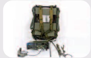
El ES/PRC-9200 es un radioteléfono medio portátil de corto alcance (8 Km.) de la familia PR-4G , que trabaja en la banda de VHF y FM, de alto nivel de protección ECCM que permite efectuar transmisiones seguras en un ambiente electromagnético hostil. Se asigna a todas las Unidades del Ejército de Tierra.
