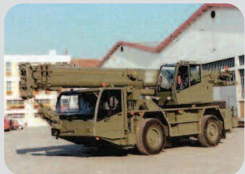
**CAMIÓN PESADO TODO TERRENO 10 TM / GRUA PEGASO IVECO M 250.37 W-23110**
