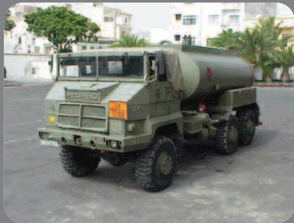
**CAMIÓN PESADO TODO TERRENO 10 TM / CISTERNA / PEGASO IVECO M 250.37 W 23 FKO**
