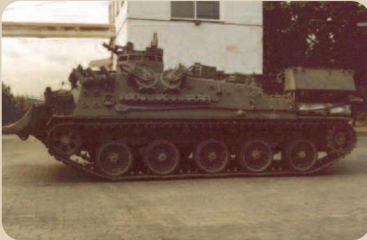
En la parte frontal está situada la pala, que está accionada hidráulicamente por dos cilindros y es controlada por el conductor. Se utiliza como pala y para estabilizar al vehículo cuando se opera con la grúa. La grúa tiene capacidad para levantar una carga de 12 t. El cabestrante (torno) principal está montado en el centro del casco y el auxiliar en el frente.
