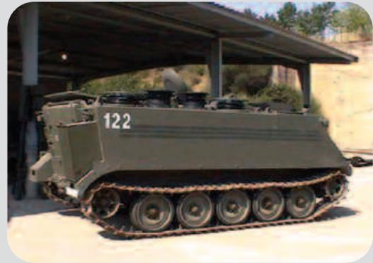
El Motor es GM Diesel modelo 5063-5299 6V53, 215 CV. Y la Transmisión tipo Allison GMC TX 100-1 (Tres velocidades hacia delante y una hacia atrás).
