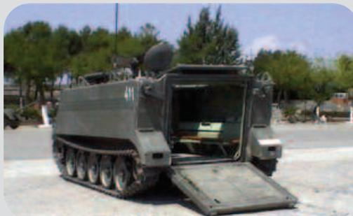
Es un vehículo ligero acorazado sobre cadenas para el transporte del personal, de origen estadounidense, desarrollado a partir del año 1956 para ser aerotransportado en helicóptero y avión de carga.
