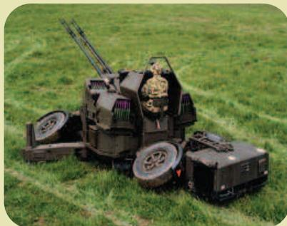
Con Calibre 35/90mm., su alcance máximo eficaz es 4.000 m. con dirección de tiro y el alcance máximo horizontal 11.200 m. Emplea munición rompedora ordinaria, rompedora trazadora y perforante. La dirección de tiro es SKYGUARD. SDT: con periscopio láser y calculador "Gun King". Con este dispositivo de puntería autónomo y optrónico el apuntador no tiene que estimar los parámetros de situación al blanco.
