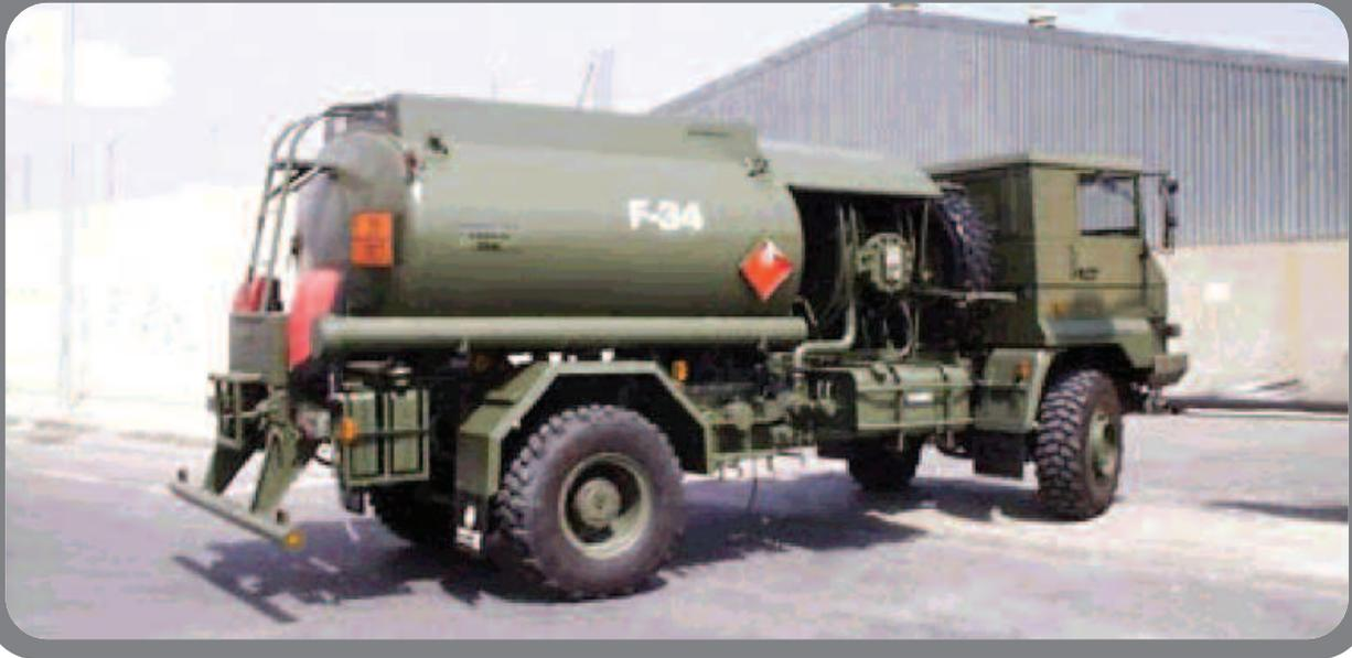
**CAMIÓN MEDIO TODO TERRENO 6 TM / UNIDAD REPOSTADORA HELICÓPTEROS / PEGASO 7323 ( 9500 L)**
