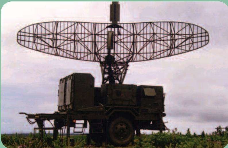
**RADAR DE ADQUISICIÓN CWAR SISTEMA DE MISILES ANTIAÉREOS HAWK AN/MPQ-55**
