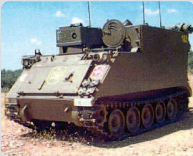
Velocidad máxima: 65 Km./h. Autonomía: 480 Km. Capacidad de franqueo: Pendiente vertical 60%, lateral 30%, obstáculo frontal 0,61 m. y horizontal 1,66 m. Capacidad de vadeo: Anfibio. Visión nocturna: IR para conductor. Protección Blindaje de aluminio de 40 mm .de espesor, que protege a la tripulación del fuego de las armas de pequeño calibre, de la metralla, cascos o esquirlas. Transmisiones. Dispone de equipo interfónico AN/VIC 1, y equipos de radio AN /VRC-64 y AN /VRC-12.
