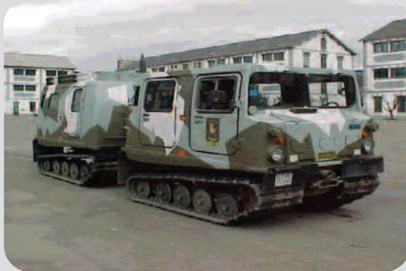
En el módulo delantero está instalado el motor. Por las características de los materiales pueden resistir temperaturas inferiores a los -40°. También puede ser aerotransportado por aviones C-130 Hércules y helitransportados por CH-47 o en un Superpuma separando los dos módulos, siendo posible su extracción LVAD (lanzable desde un avión a baja altura) y LAPES ( por paracaídas a baja altura).
