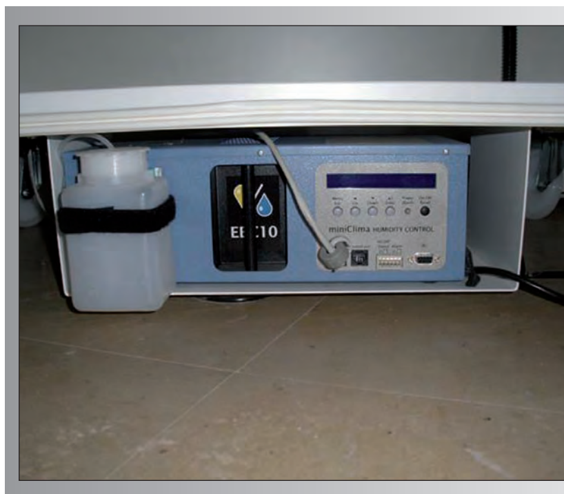
Aparato de climatización. Existen vitrinas con "mini-clima": Incidiendo en el control de la humedad y la temperatura presente en el espacio expositivo, es posible establecer unas condiciones medioambientales específicas para las piezas que contiene un mueble determinado
