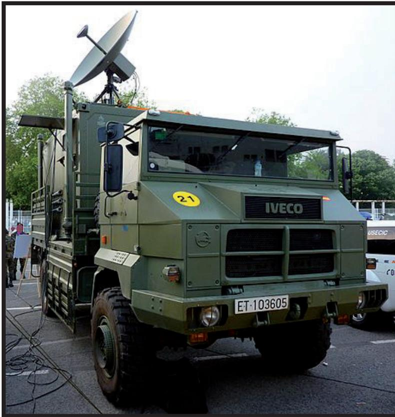
Iveco Pegaso 7226 con el sistema de Mando y Control SIMACET GU
