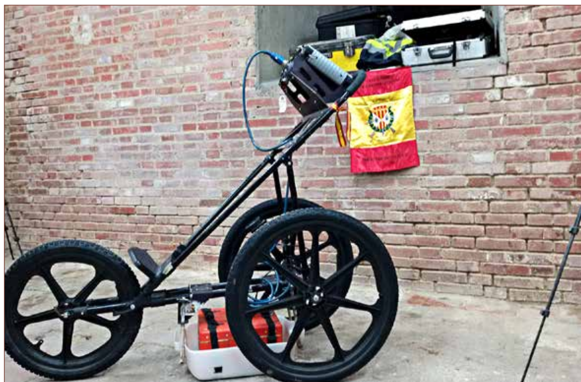
Georadar empleado en la cripta del convento de las Trinitarias Descalzas
