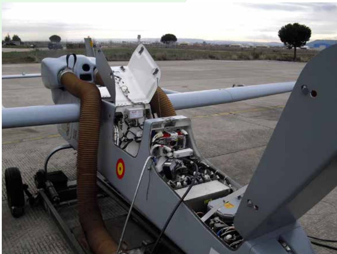
Aeronave tipo PASI durante las pruebas de compatibilidad electromagnética en el INTA
