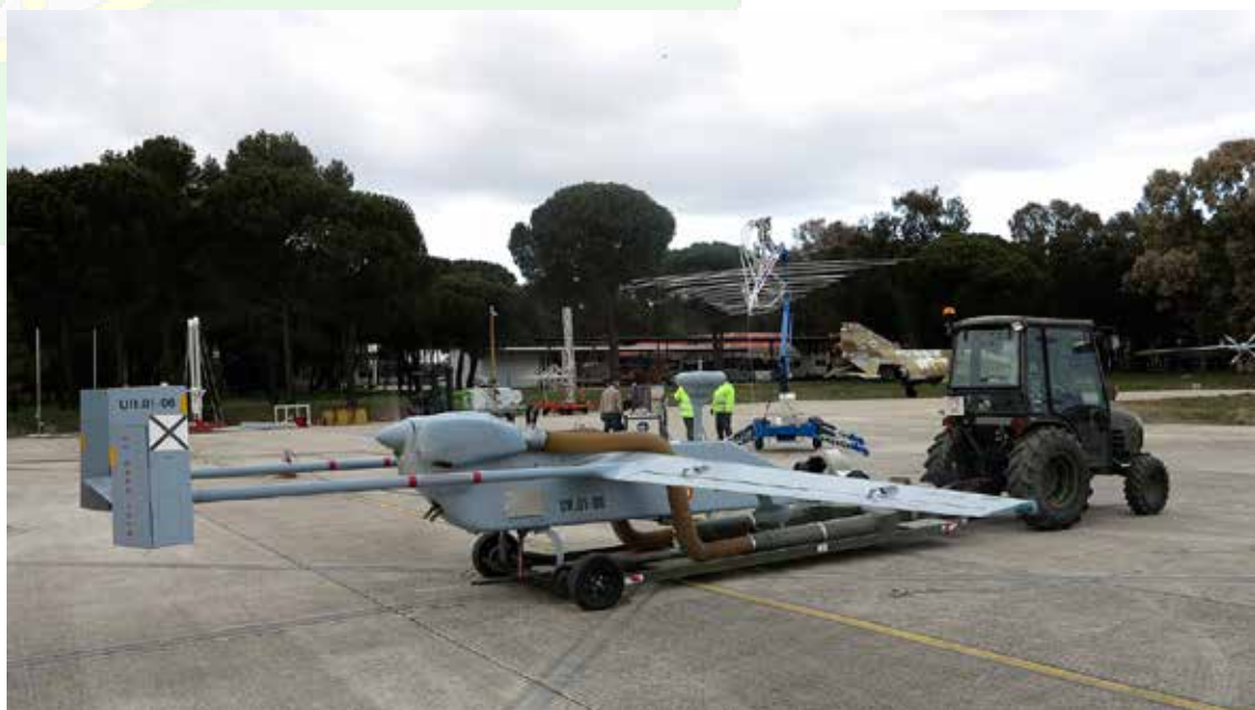
Pruebas de compatibilidad electromagnética del sistema PASI en el INTA
