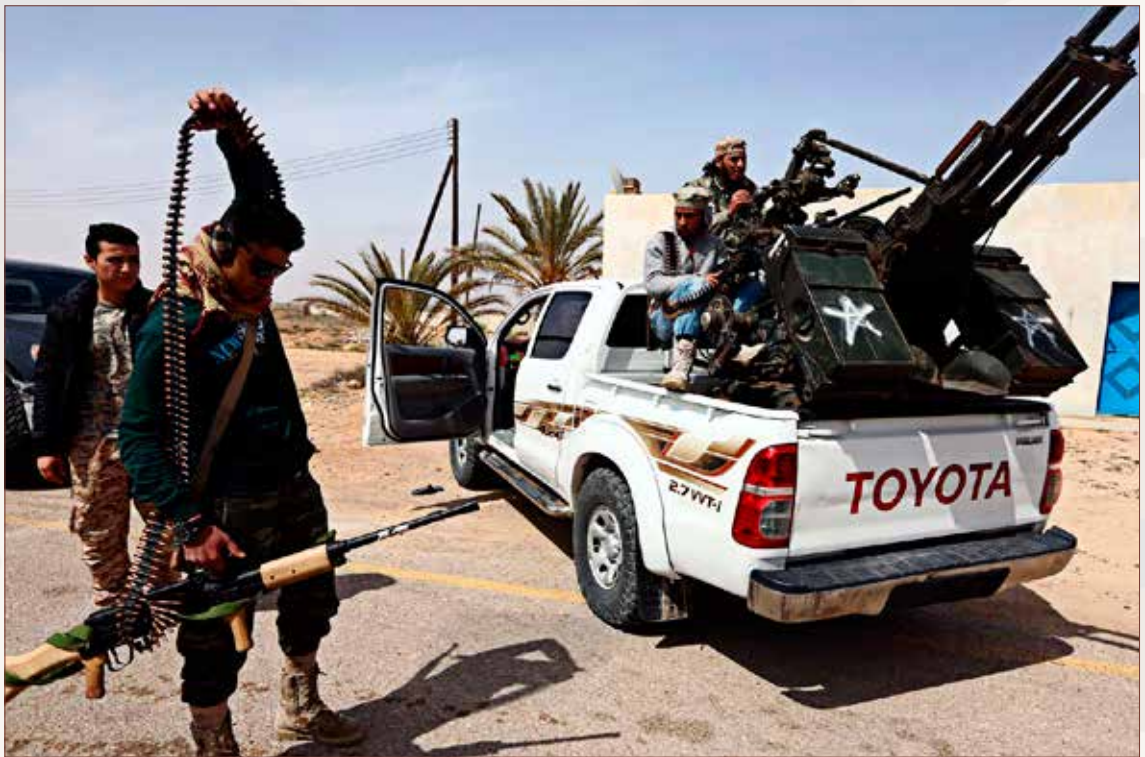
Toyota armado con un montaje doble de 23 mm. Estos vehículos admiten una enorme variedad de armamento, desde ametralladoras pesadas a lanzacohetes
