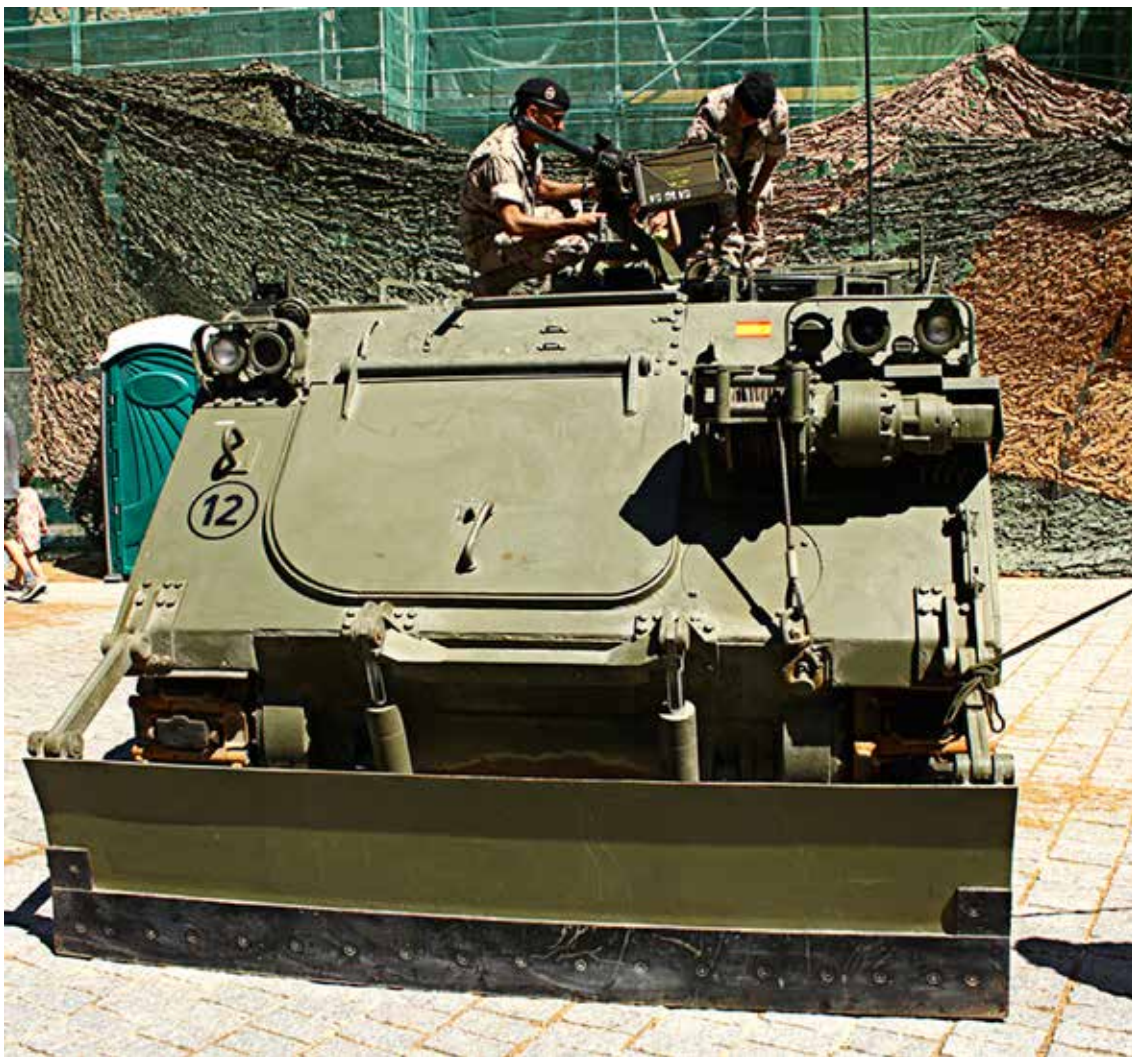
Vehículo blindado de zapadores. Las brigadas cuentan con medios que aseguran la movilidad y a la vez la protección C-IED
