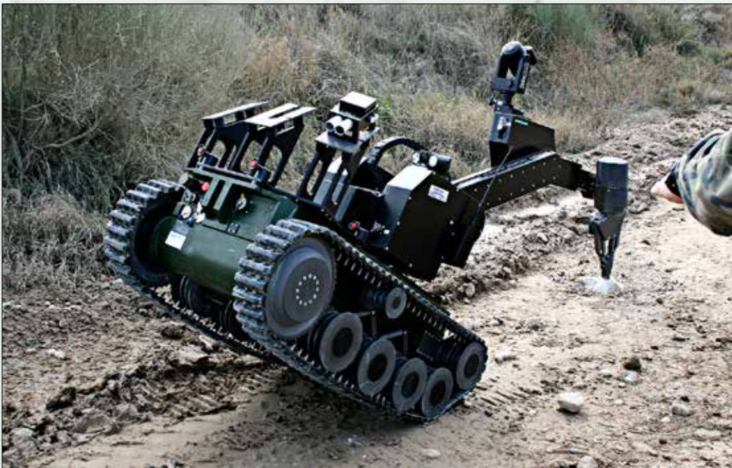
Un moderno robot de C-IED en labores de reconocimiento de un objeto sospechoso
