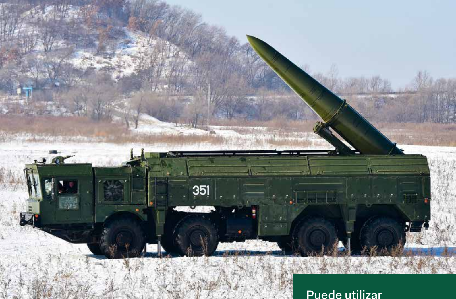
Camión 8x8 MZKT-79306 ASTROLOG que porta un TEL ( Transporter Erector Launcher )
