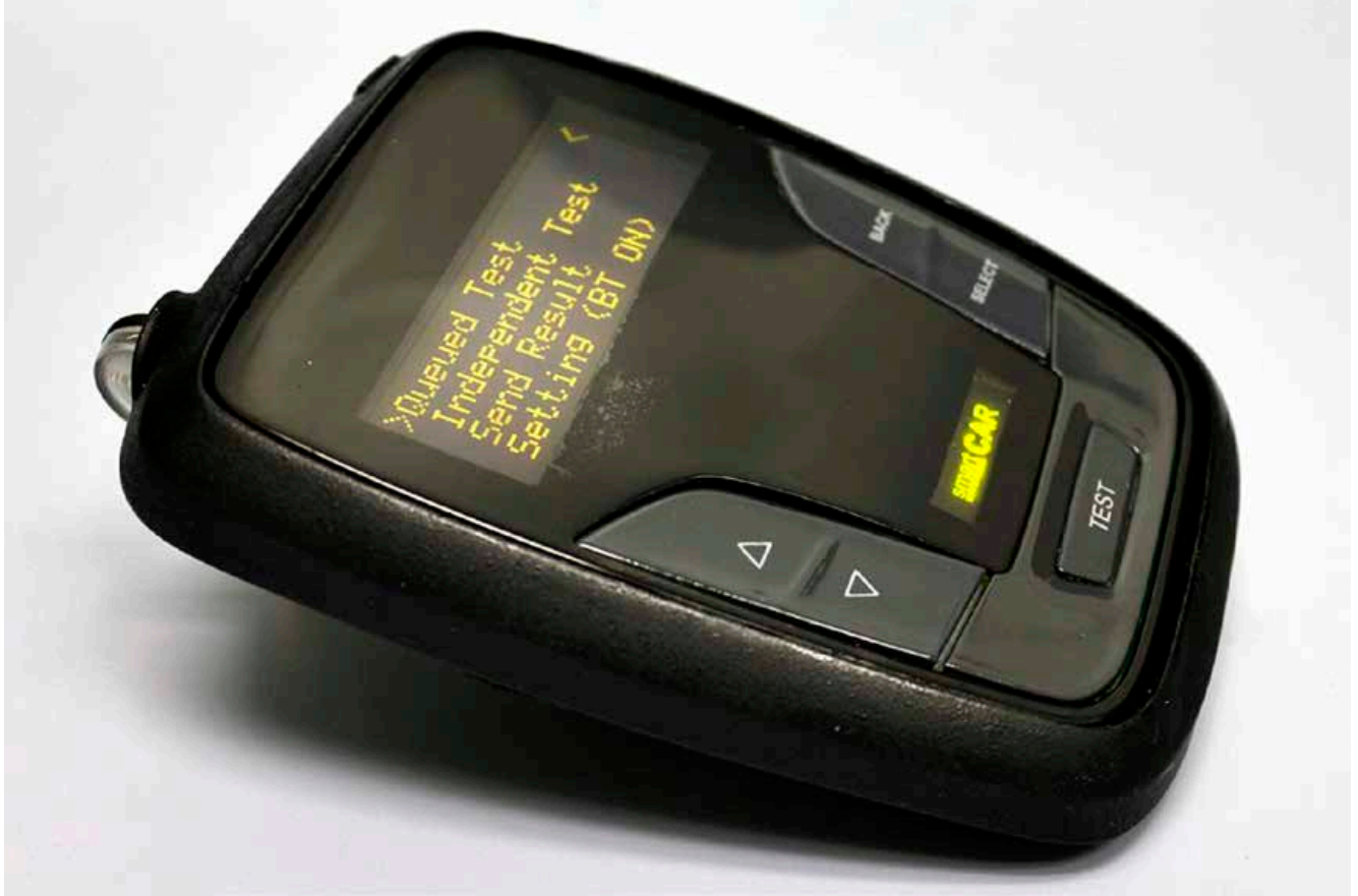
Biosensor colorimétrico desarrollado por el U.S. Army Edgewood Chemical Biological Center que permite enviar los resultados en tiempo real al puesto de mando. Crédito: U.S. Army
