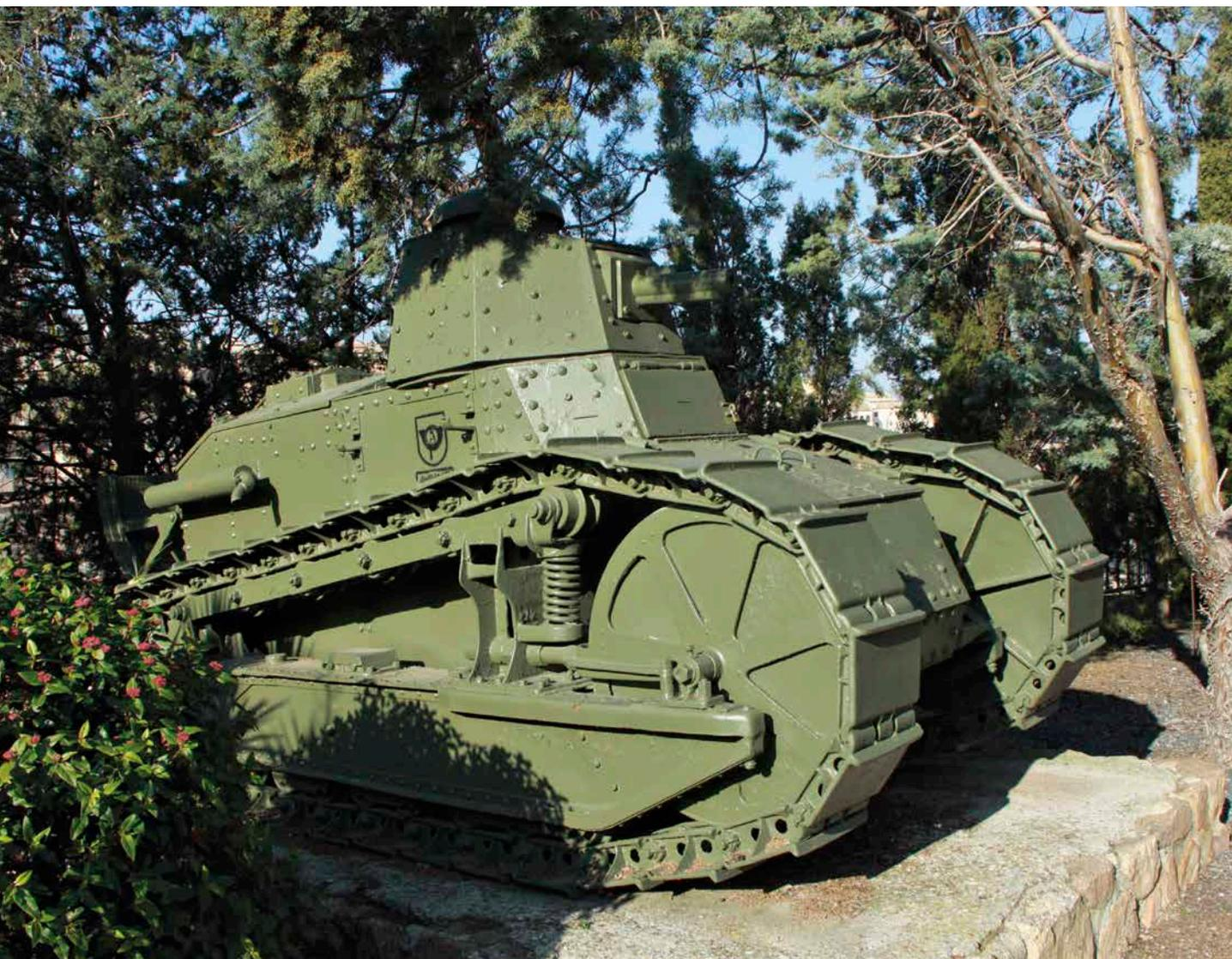
Su peso, en el caso de los provistos de ametralladora, era de 6500 kg. Alcanzaba una velocidad máxima de 7,8 km/hora, con una autonomía de 80 km.
