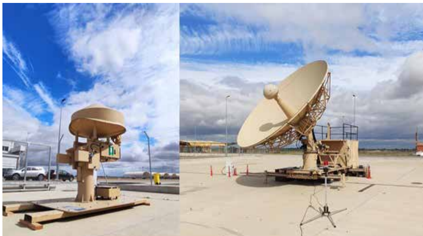
Vista de las antenas de guiado terrestre (Ground Data terminal-GDT) a la izquierda de la imagen y de enlace satelital (SETSS). Imagen cedida para este artículo por el Ala 23
