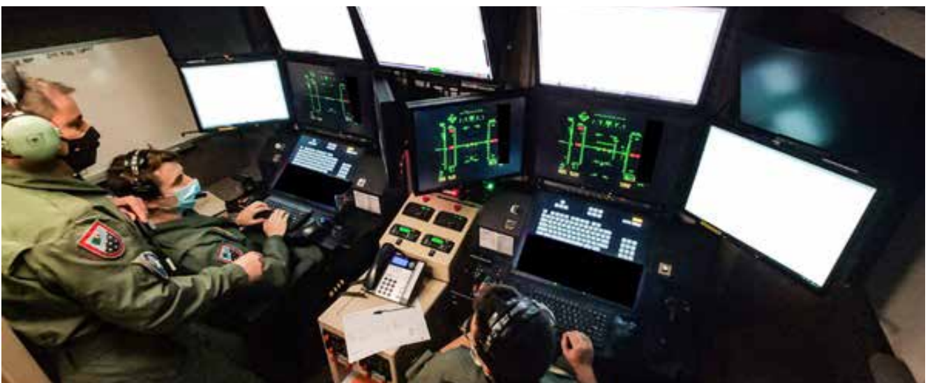
Imagen 7 – Interior de la GCS, puesto del piloto (izquierda de la imagen) puesto del Operador de Sensores (derecha de la imagen) Imagen cedida para este artículo por el Ala 23
