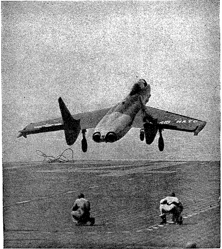
El avión F-70 , cuyas características son carecer de cola y tener una sola ala, en el momento de ser catapultado desde el portaaviones Midway .
