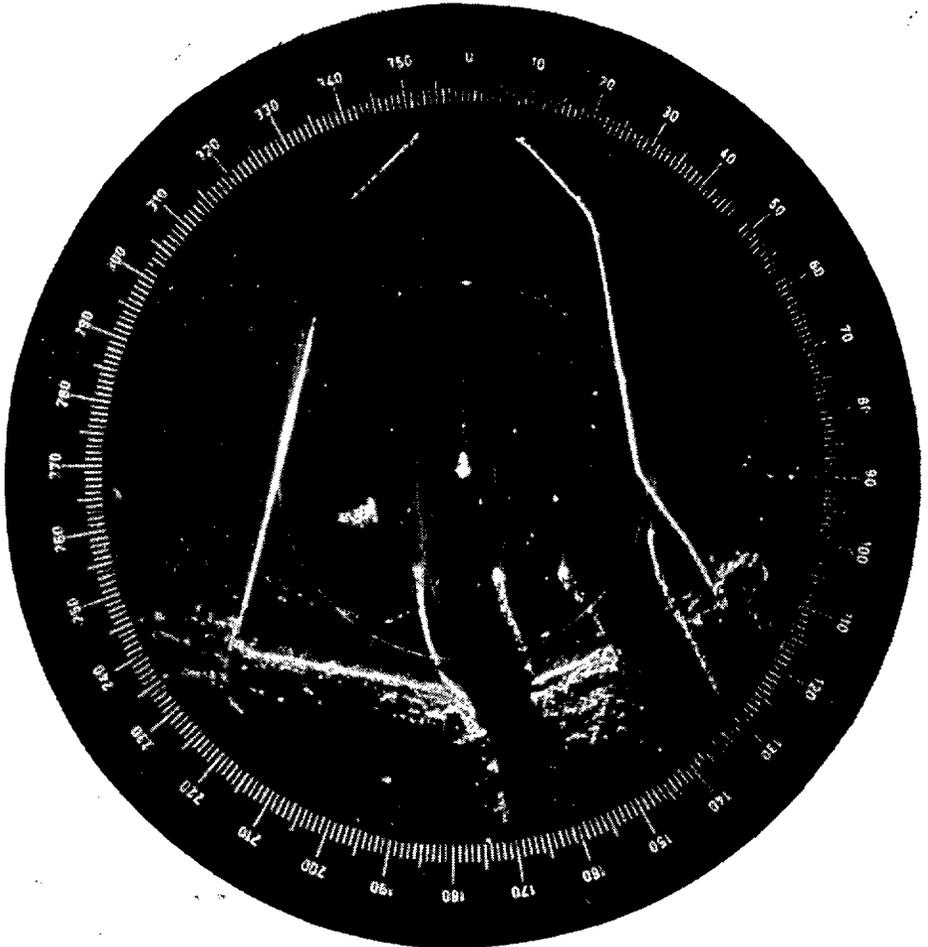
Figura 2. Puerto de Ijmuiden (Holanda).—Fotografía realizada con un equipo de *High definition*. Philips, de 8 mm (escala 0,5 millas).
