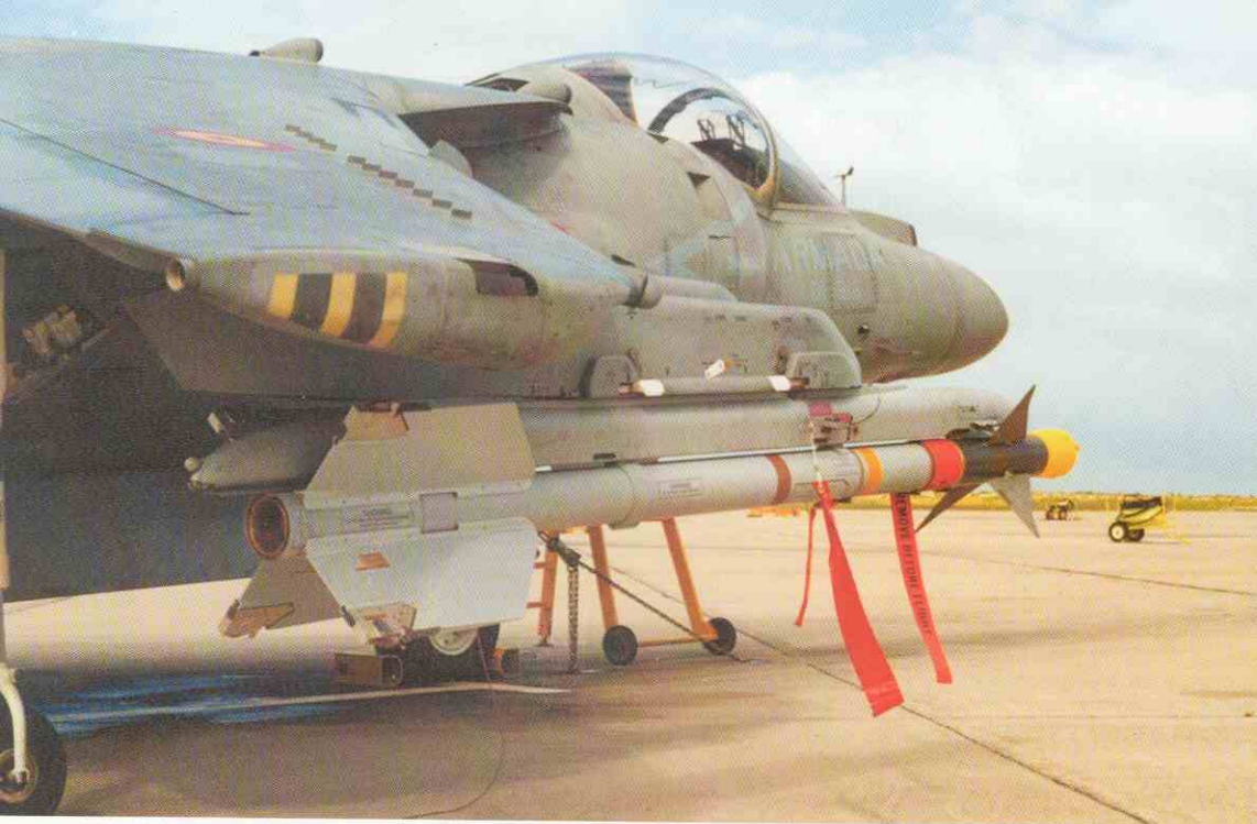
Avión Harrier Plus con un misil de combate Sidewinder AIM-9L/I. (Foto: L. Díaz-Bedia).
