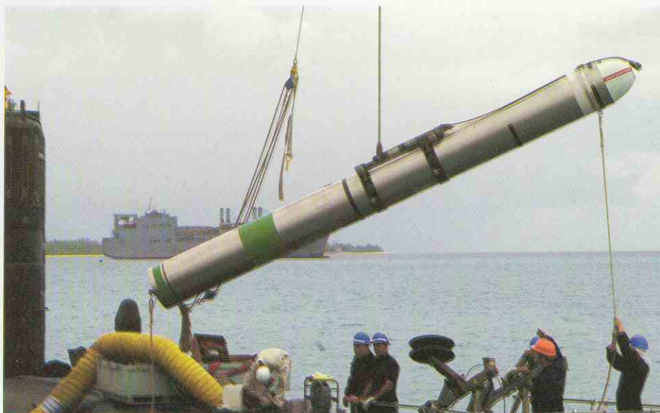
Recarga de un misil Tomahawk en un submarino clase Trafalgar , en Diego García, tras su uso en la operación LIBERTAD DURADERA.
