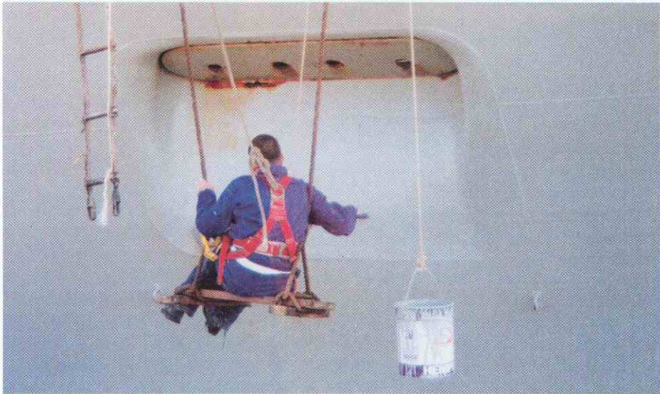
Reparando detalles en zonas fácilmente oxidables. (Foto: D. Quevedo Carmona).
