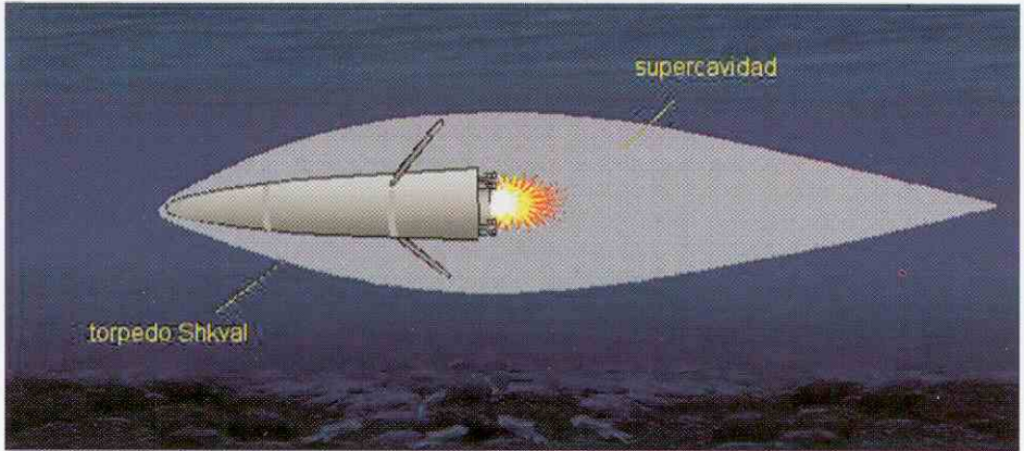
Interpretación gráfica del fenómeno de la supercavitación (ilustración del autor del artículo).
