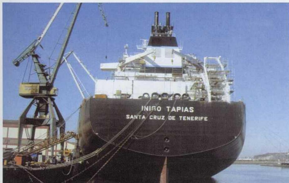
a 163° C en cuatro tanques que disponen de una doble membrana tipo N.º 96 como sistema de aislamiento y contención de la carga, por lo que en esta construcción Izar ha tenido muy presente que estos buques de gran tecnología y alto valor añadido exigen requisitos de seguridad muy concretos, debido al tipo de carga que transportan, como el doble casco, el doble fondo en la zona de carga y los cuatro tanques criogénicos de doble membrana lisa del tipo citado.
