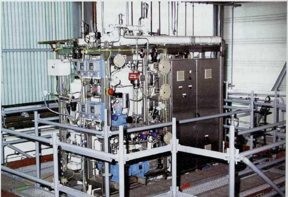
Figura 2.—Prototipo de reformador de material desarrollado por HDW (cortesía de HDW).
