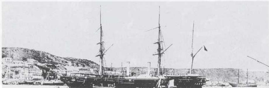
arqueo de 1.000 t, 69,5 codos de eslora (codo de ribera o real equivalente a 0,574 m), 17,33 de manga y 12,25 de puntal; fue construida con tabla y clavazón dobles con el fin de que aguantase mejor la artillería, la vela y la mar.
