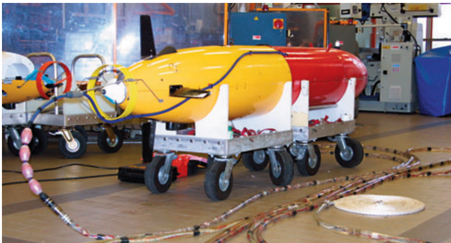
Figura 5: otra imagen de un vehículo Ocean Explorer , esta vez mostrando la matriz acústica remolcada SLITA, desarrollada por el NURC.
