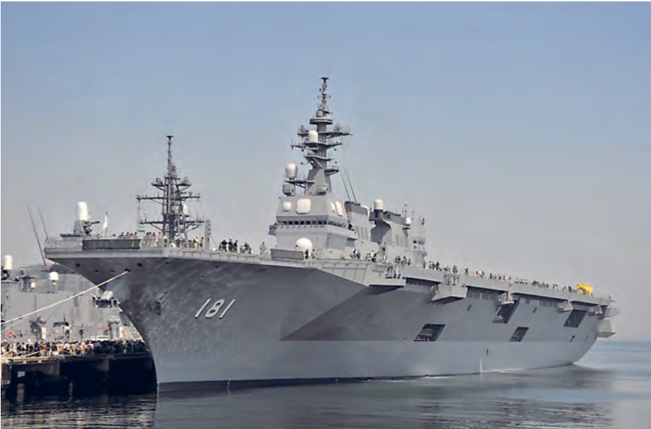
Una de las últimas adquisiciones de la Armada de Autodefensa Japonesa. El Hyuga es oficialmente un DDHG o destructor misilístico con facilidades para operar con helicópteros. ¿Podrá operar también con aviones del tipo STOVL ? (Foto: J. de Dios Dacal).
