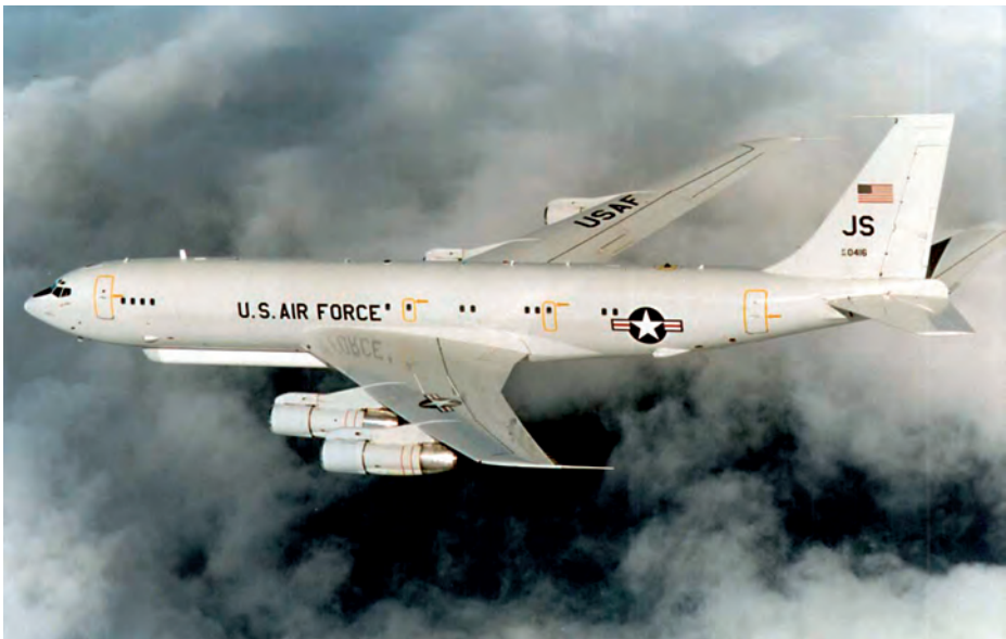
E 8 Istars . Obsérvese el radar situado bajo el fuselaje.
