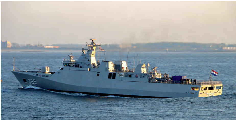
Corbeta indonesia Diponegoro construida en Holanda (de ahí la bandera a popa), cabeza de una serie de cuatro. Posee un desplazamiento de 1.700 t, lo que la convierte casi en fragata con un poderoso armamento. (Foto: J. de Dios Dacal).
