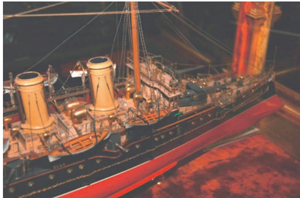
Figura 3.— Una vista del detalle de la cubierta alta del Regente con sus altas bordas, una auténtica piscina capaz de atrapar hasta 500 t de agua en el temporal del 10 de marzo, según estimación de Villaamil y Castellote, lo que supondría una disminución muy notable de su estabilidad transversal. (Museo Naval. Madrid).
