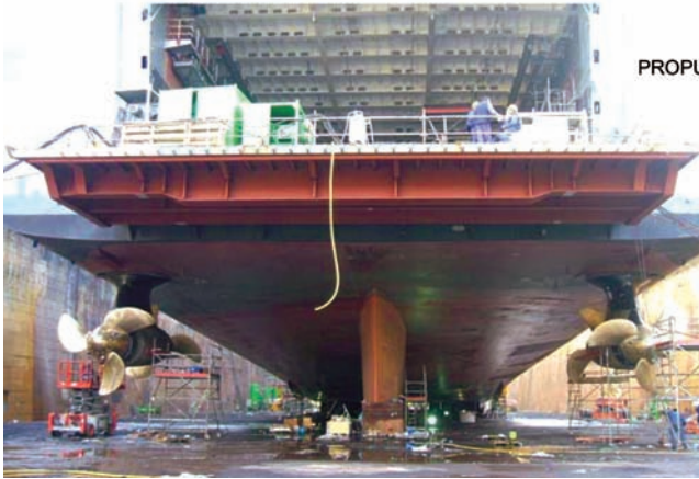
El LHD durante el montaje de las hélices.
