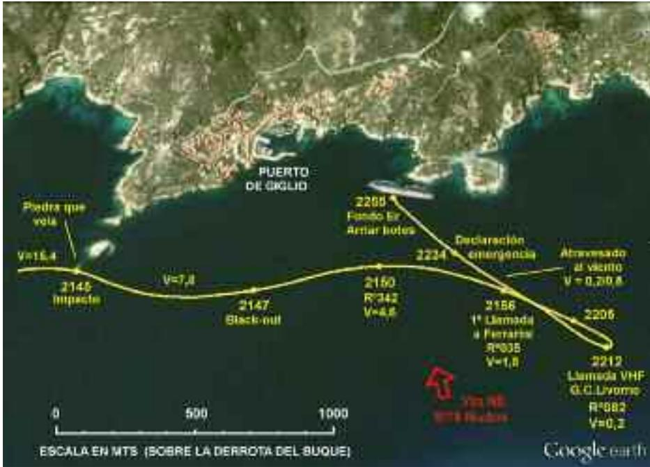
Trayectoria seguida por el *Costa Concordia* entre el impacto inicial con el escollo y la embarrancada final: la derrota está determinada proyectando el *track* histórico del radar sobre la foto aérea en vista cenital (antes de darle perspectiva), por lo que debería ser razonablemente exacta. Debido a esta perspectiva, la escala solo es válida para la zona de la trayectoria. (Elaboración propia a partir de datos del VDR del buque y una imagen de Google Earth, que incluye el casco del crucero).
