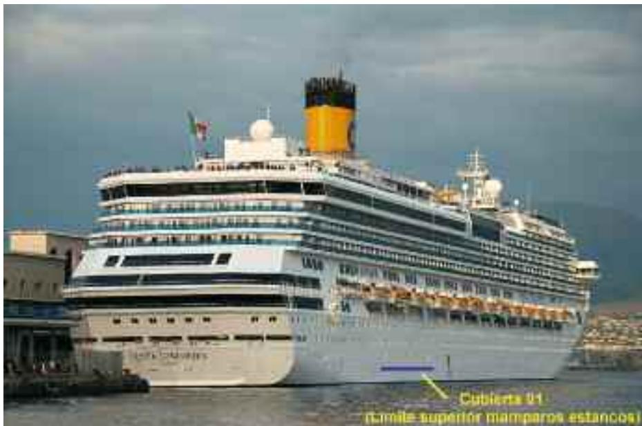
El crucero *Costa Concordia* atracado en el puerto de Nápoles: se aprecia su enorme manga y la ubicación de la cubierta «01», que constituye el límite superior de los mamparos estancos. A la derecha de la línea azul que marca esta cubierta, hay una porta de costado abierta con la escala de práctico arriada. (Edición propia de una foto de Fabrizio Reale).
