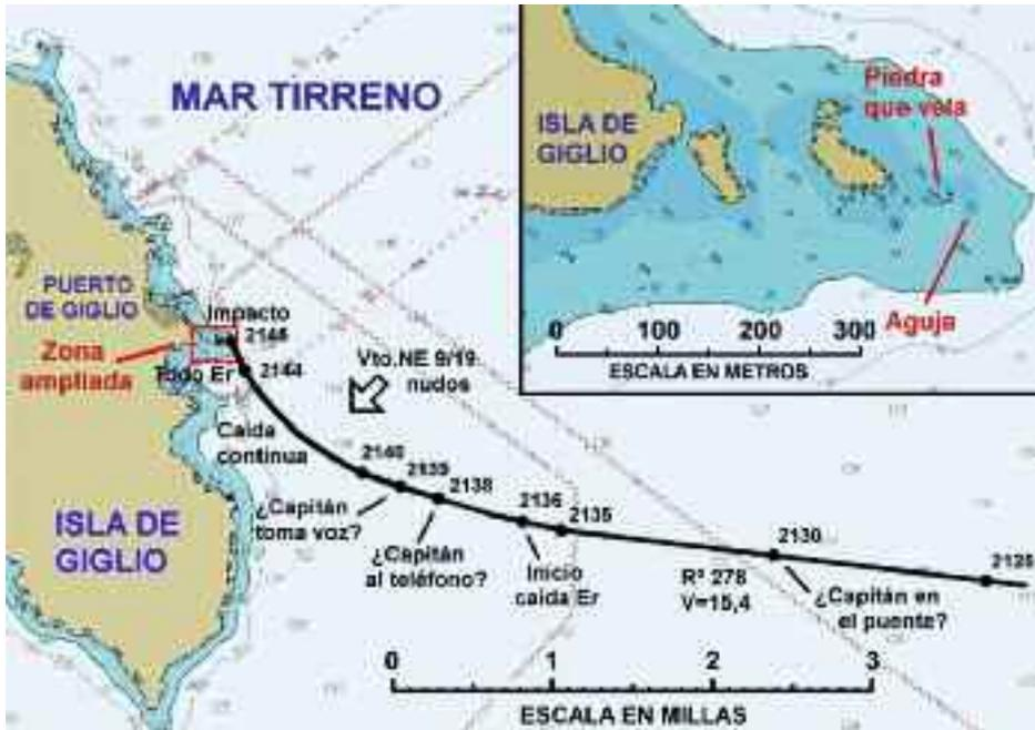
Derrota del *Costa Concordia* los 20 minutos previos al primer impacto. Las horas entre signos de interrogación son aproximadas dentro de un margen bastante estrecho; la derrota, al estar trazada a partir de posiciones GPS de la presentación radar grabada en la caja negra, debería ser casi exacta. Los datos del viento proceden del anemómetro del propio buque, que también alimentaba la presentación del radar ARPA. (Elaboración propia a partir de datos del VDR del buque y cartografía digital).
