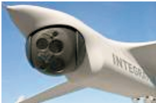
Carga útil del RQ-21.
