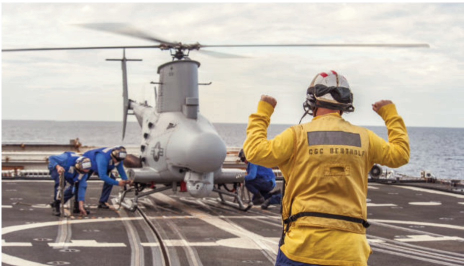
Calzos y trincas para un MQ-8B Fire Scout .
