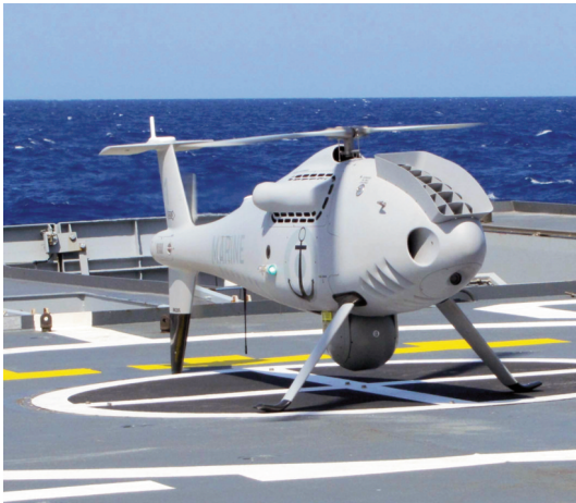
UAV S-100 sobre cubierta.
