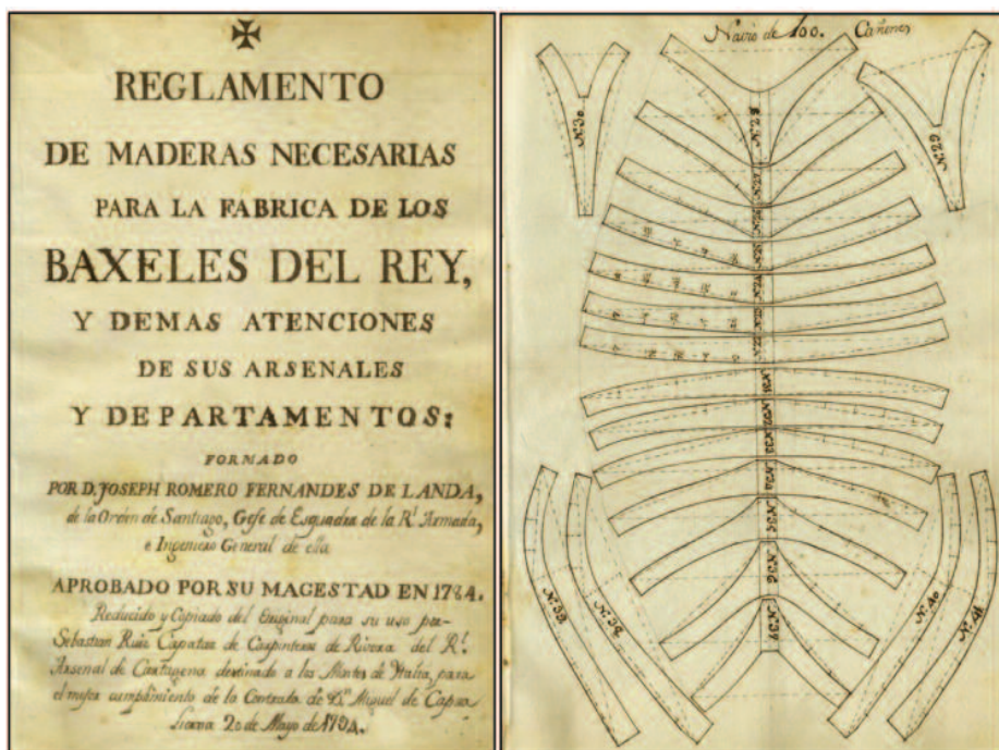
Figura 5. Reglamento de maderas para navíos de 100, 74 y 64 cañones y para fragatas de 36. (Museo Naval de Madrid).
