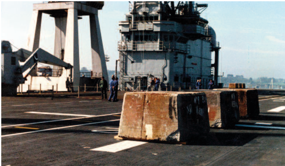
Experiencia de estabilidad del portaviones Príncipe de Asturias en 1982.
