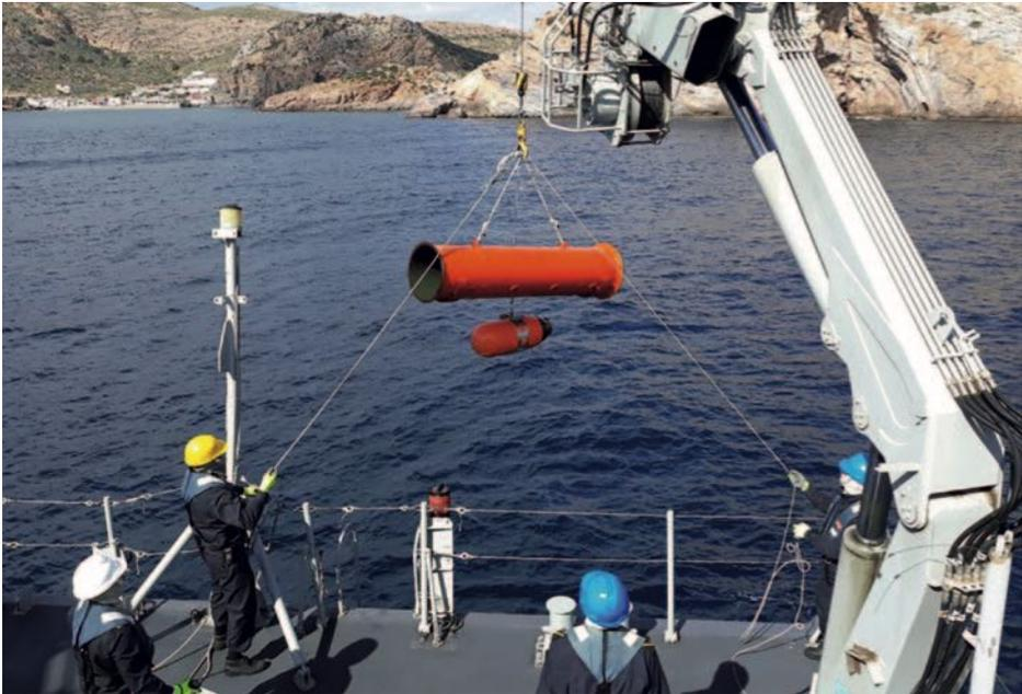
Recogida de mina y carga de contraminado en un ejercicio del cazaminas *Tajo* frente a El Portús. (Foto del autor).
