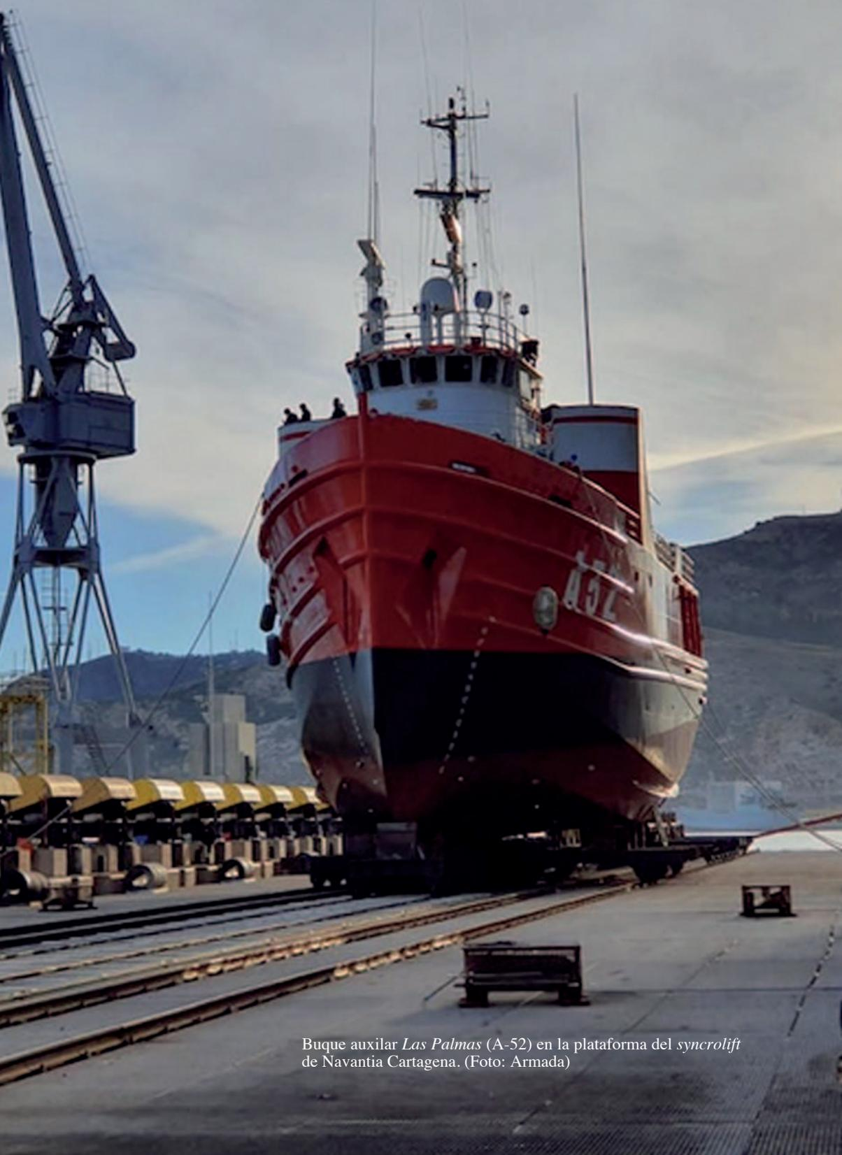
Buque auxiliar *Las Palmas* (A-52) en la plataforma del syncrolift de Navantia Cartagena. (Foto: Armada)
