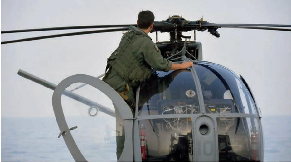
Personal de mantenimiento realizando inspección prevuelo. (Fuente: OCS AJEMA)
