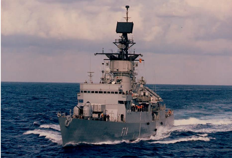
Fragata *Asturias* (F-74). Antena del radar AN/SPS-52. (Foto: Armada)
