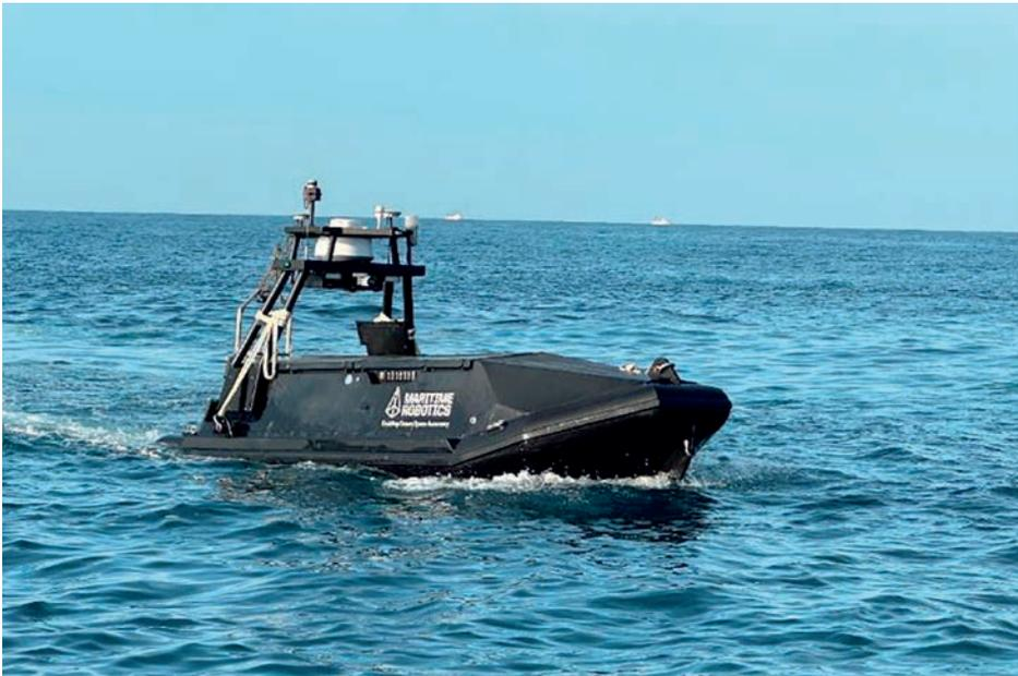
El USV *Sonda 01* realizando trabajos hidrográficos. (Fuente: ALMART)
