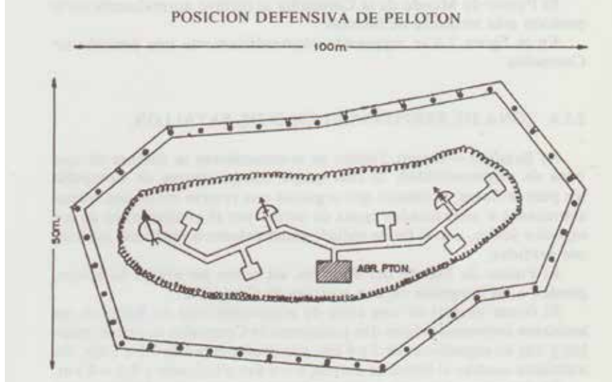
Ilustración 22. Posición defensiva de pelotón. Manual ET 1989. Fortificación para las Armas y los Servicios, págs. 2-5
