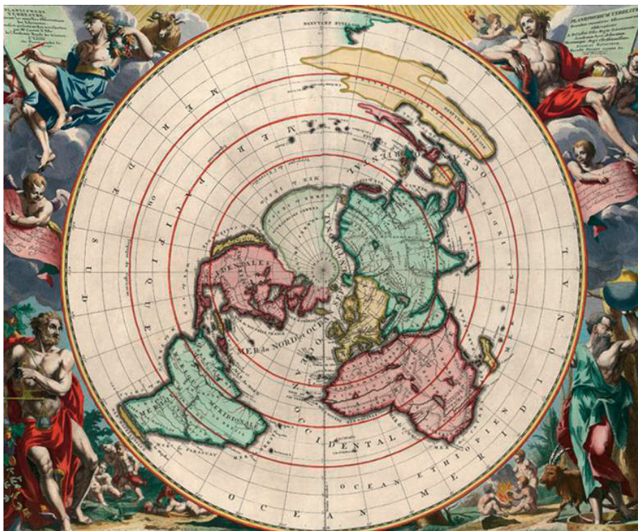
Planisferio de Cassini. Los meridianos se situaron en él de acuerdo con las longitudes deducidas por la observación de los satélites galileanos de Júpiter.
