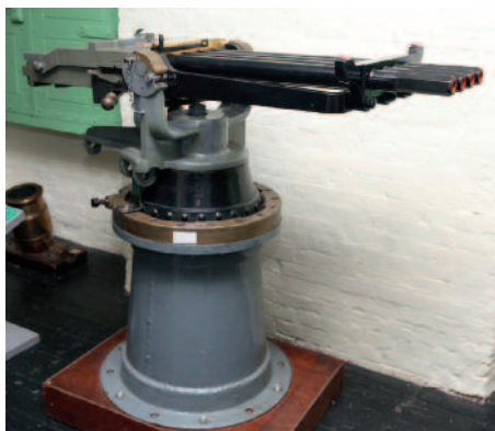
Ametralladora Nordenfält de 25,4 mm, de cuatro cañones, en montaje naval. No tiene instalado el cargador en la parte superior del montaje y le faltan los volantes de accionamiento. (Foto: Archivo MdR Almirante de Castilla)
